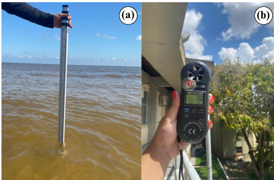
Figura 21 - Medições de altura de ondas e ventos locais; (a) régua topográfica para medição de altura de passagem de onda; (b) Anemômetro modelo AD-250 para as medições de velocidade dos ventos. Fonte: Autora.
