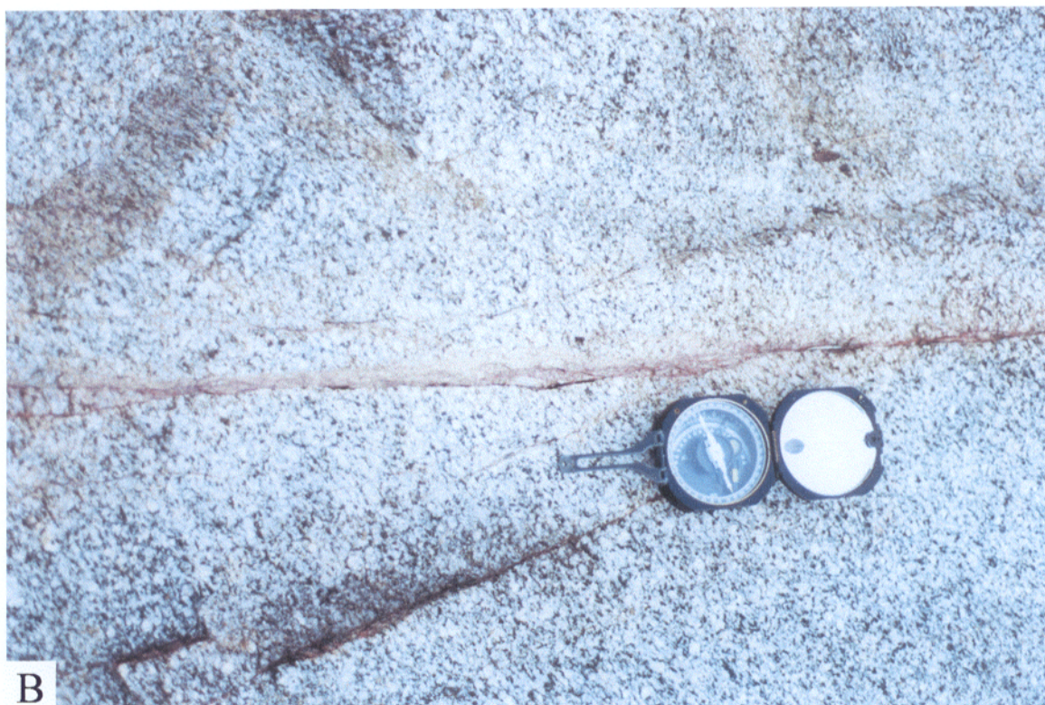
Figura 12- A) Zona milonítica, observando-se diferença de coloração da rocha, sendo a parte mais escura a porção mais deformada; afloramento 49. B) Rocha anisotrópica com foliação marcada, principalmente, pelos minerais máficos; esta feição é dominante no stock norte, afloramento 49.
