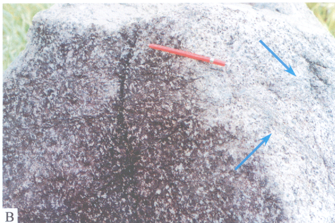
Figura 11- A) Feição isotrópica do GSR, que é predominante no stock sul. B) Rocha com leve foliação marcada pelos grãos de quartzo, as setas apontam a formação de pares conjugado, NX, amostra AC-24.
