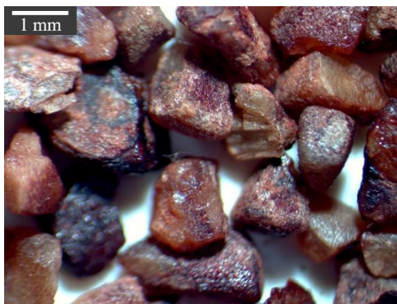
Figura 31 – Partículas lavadas para retirada das micropartículas.
