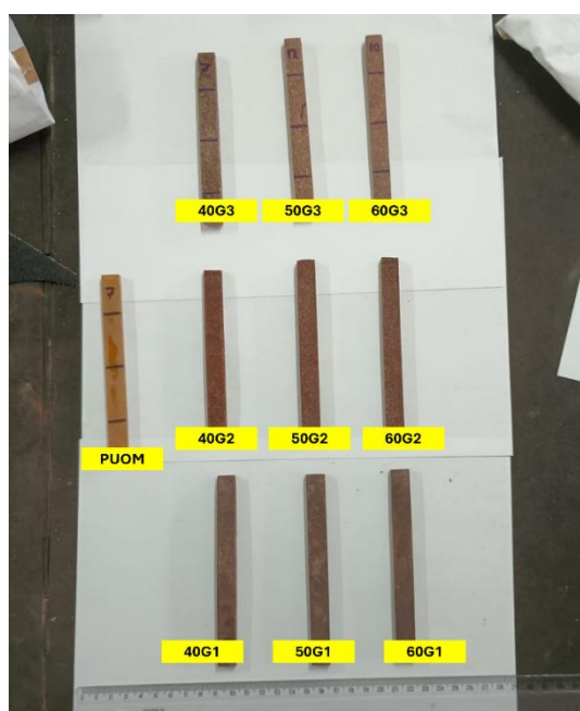
Figura 45 – Corpos de provas após o ensaio de dobramento.
