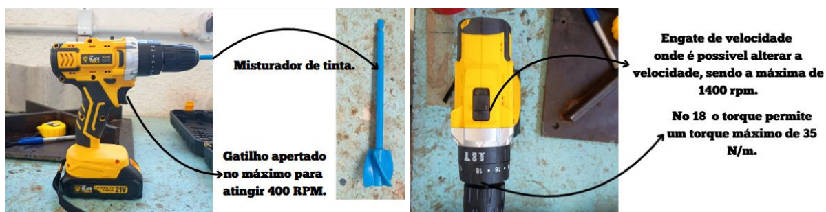
Figura 20 – Esquema do uso da parafusadeira como misturador mecânico.
