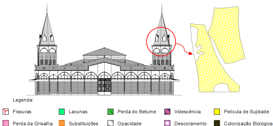
Figura 60: Diagnóstico de danos do Mercado do Ver-o-Peso. (Elaborado a partir de base cadastral do IPHAN).
