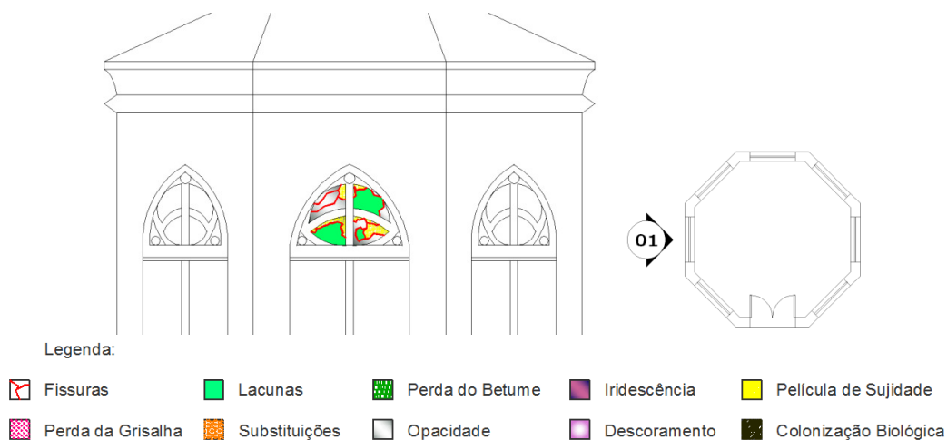
Figura 59: Diagnóstico de danos da área de coleta do Mausoléu Sem Identificação, Cemitério de Santa Izabel.
