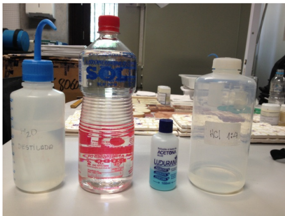
Figura 52: Solventes utilizados na limpeza dos fragmentos de vidro a serem colados: água destilada, álcool, acetona e ácido clorídrico 1:4.
