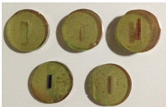
Figura 51: Seções polidas metalizadas para análise de MEV/SED.
