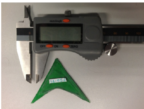
Figura 48: Paquímetro utilizado para tomada de dimensões.
