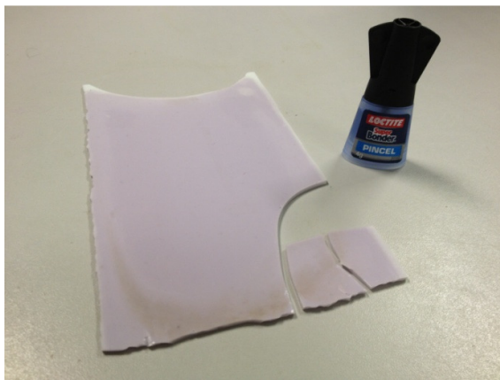
Figura 53: Fragmentos a serem colados com auxílio do adesivo à base de cianoacrilato.
