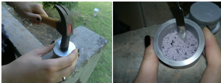
Figura 49: Processo de preparação das amostras para FRX.
