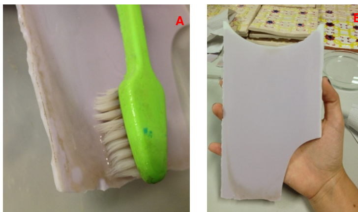
Figura 80: Limpeza da área manchada com solventes supracitados (a); Atenuação da mancha após o processo (b).
