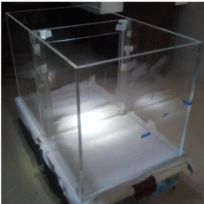
Figura 1. Caixa de acrílico com espessura de 10 mm transparente, retangular (de dimensões 70 cm x 40 cm x 40 cm), sem teto, com uma moldura interior interna centralizada para fornecer estabilidade à caixa.
