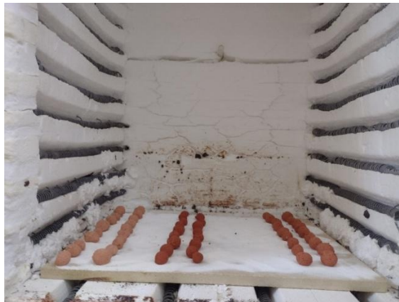
Figura 22- Agregados após o processo de sinterização na temperatura de 1100° C no interior do forno após o resfriamento gradual.
