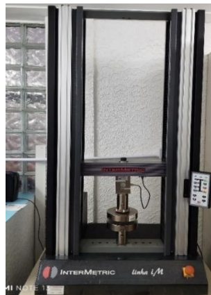
Figura 21- Máquina de ensaio compressão dos agregados sintéticos.
