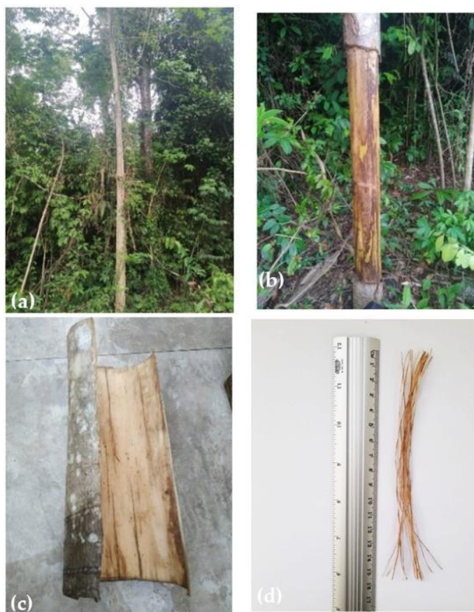
Figura 2.2- Planta de periquiteira ( a ), local de extração da casca ( b ), casca da planta ( c ) e fibras de periquiteira ( d ).
