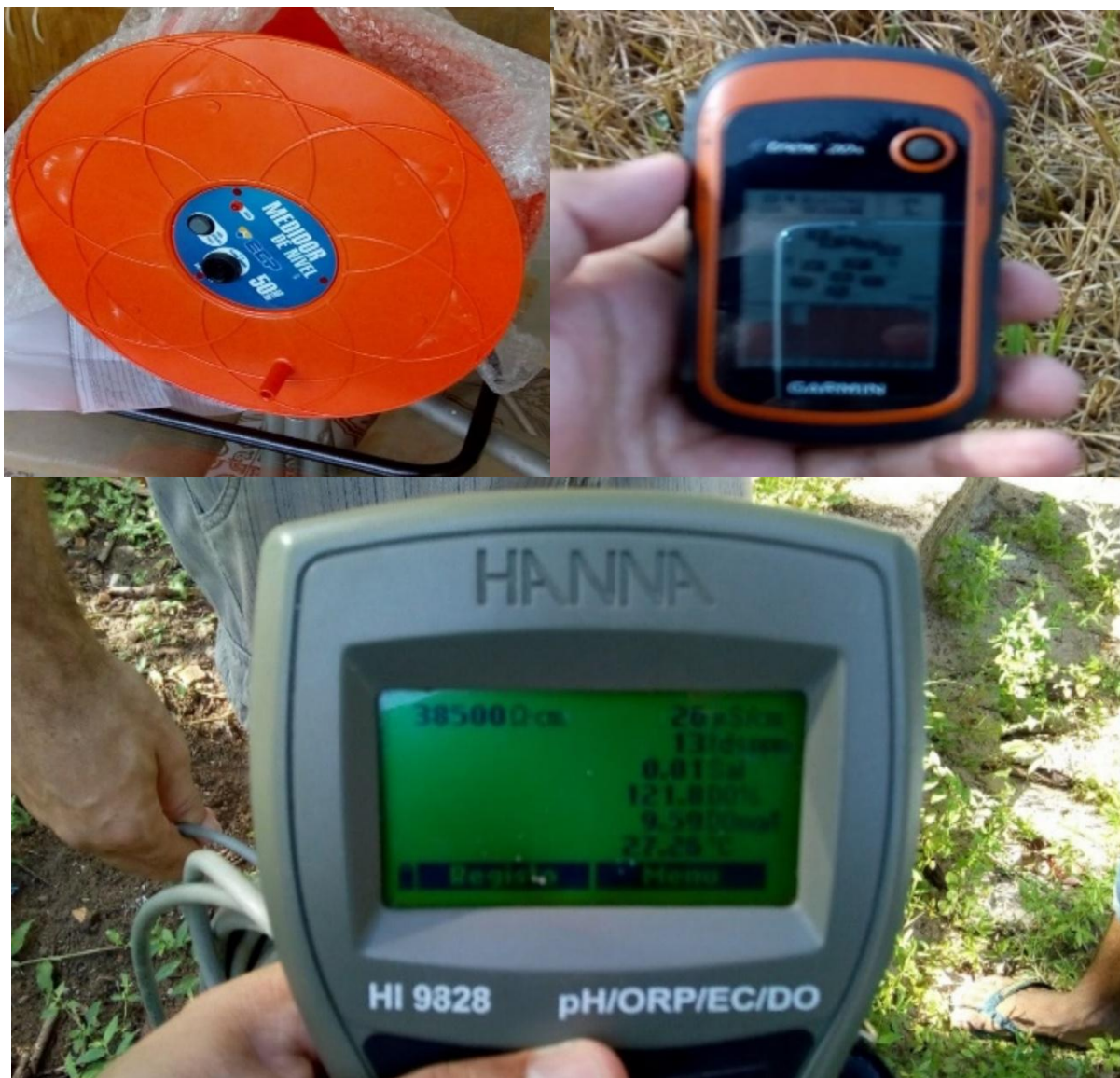
Figura 15– A: Medidor de nível usado para a etapa de campo; B: GPS Garmin modelo Etrex 30s; Medidor Multiparâmetros HANNA HI 9828.multiparâmetro.
