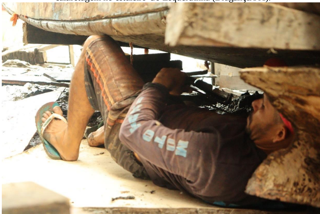
Figura 18. Calafate posicionado na parte inferior da embarcação, realizando a manutenção da calafetagem no estaleiro do Esquerdinha (Bragança/PA).
