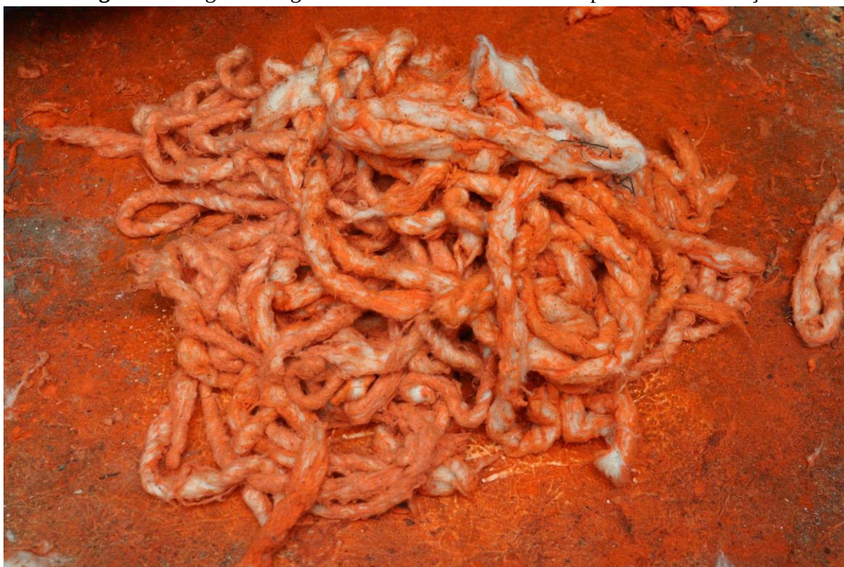
Figura 26. Algodão tingido com a mistura de zarcão em pó e óleo de linhaça.
