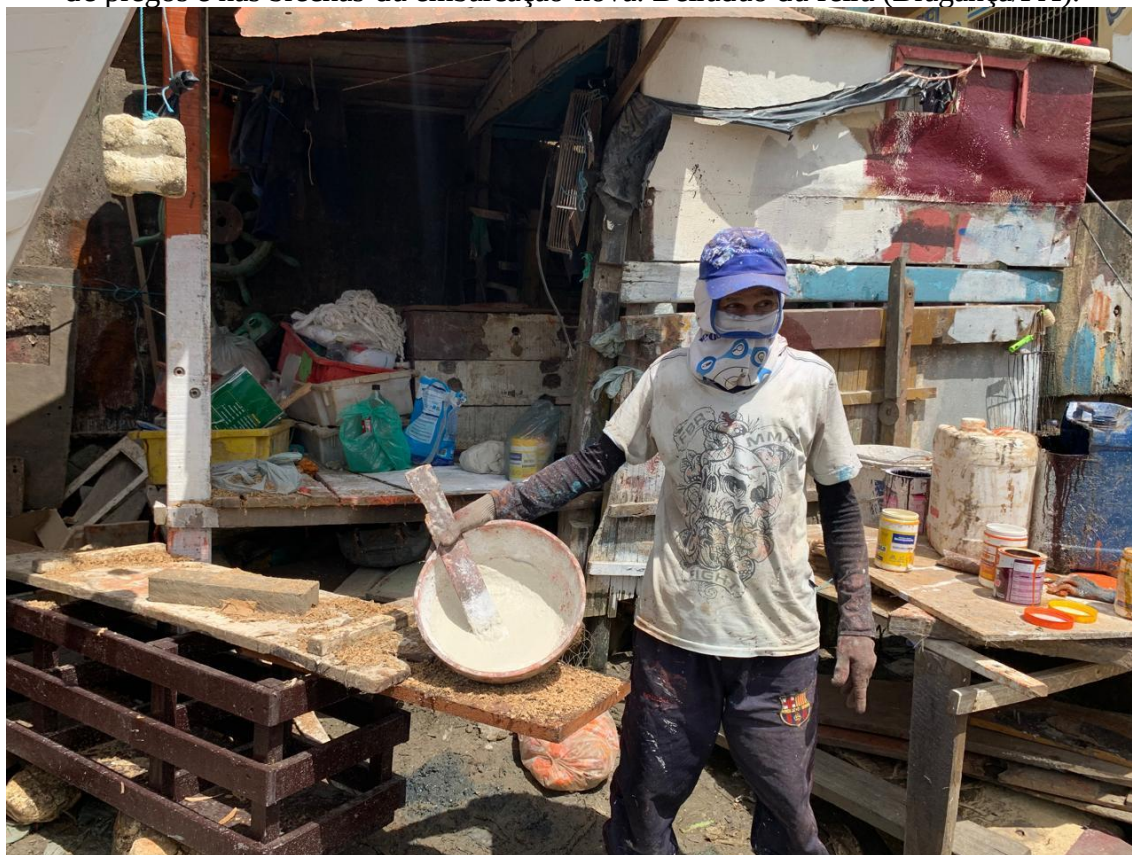
Figura 53. Calafate preparando a massa que será aplicada nas “costuras”, emendas, cabeças de pregos e nas brechas da embarcação nova. Beiradão da feira (Bragança/PA).
