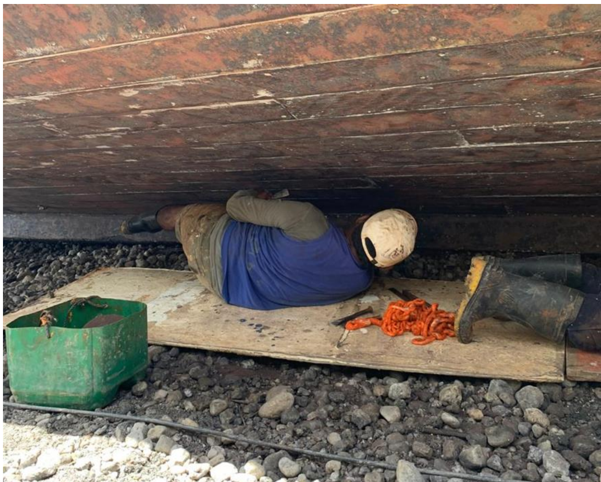
Figura 51. Calafate Walmir realizando o estopamento de uma embarcação em uso. Beiradão da Feira (Bragança/PA).
