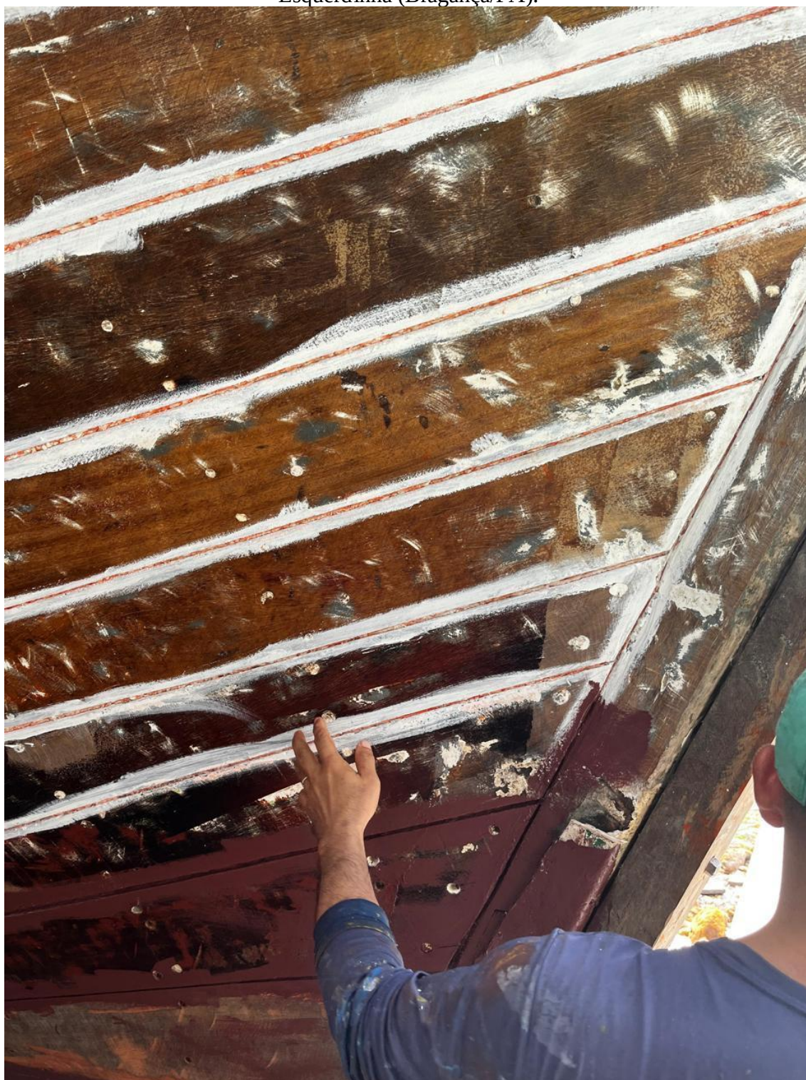
Figura 55. Embarcação nova, e etapa de finalização do emassamento. Estaleiro do Esquerdinha (Bragança/PA).
