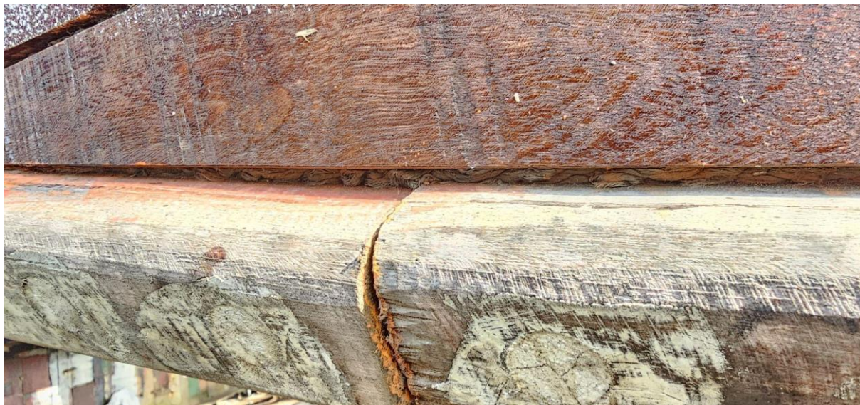
Figura 29. “Costura” da embarcação com estopa de nylon (Bragança/PA).
