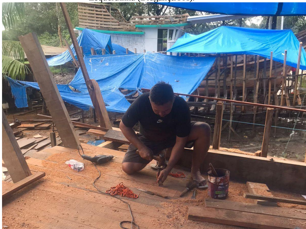
Figura 17. Movimento realizado pelo calafate para “formar a cõla” e fixação adequada da estopa dentro da “costura” da embarcação, de forma que não fique solta. Estaleiro do Esquerdinha (Bragança/PA).
