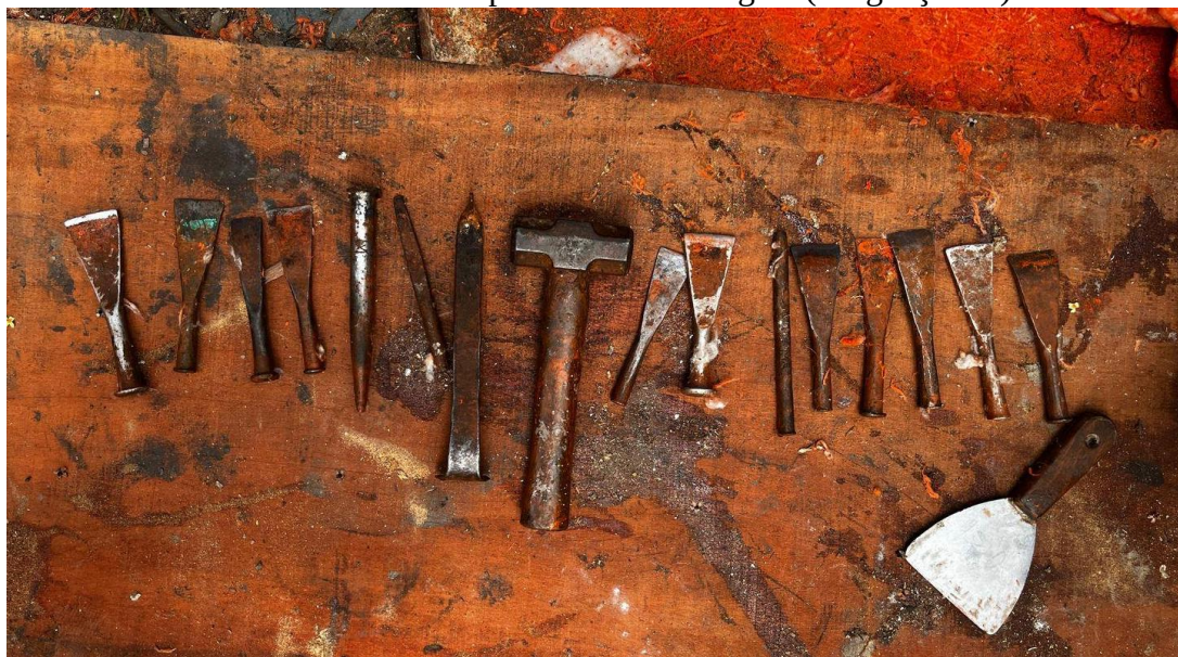
Figura 30. Ferramentas utilizadas pelos calafates, sendo a maior parte é constituída de ferro, sendo confeccionadas por ferreiros da região (Bragança/PA).
