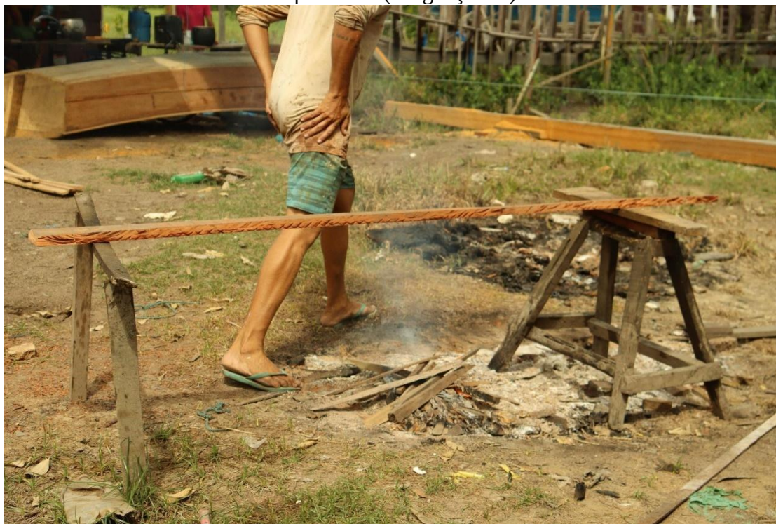
Figura 22. Tábua sendo aquecida no fogo para ser fixada na embarcação. Estaleiro do Esquerdinha (Bragança/PA).
