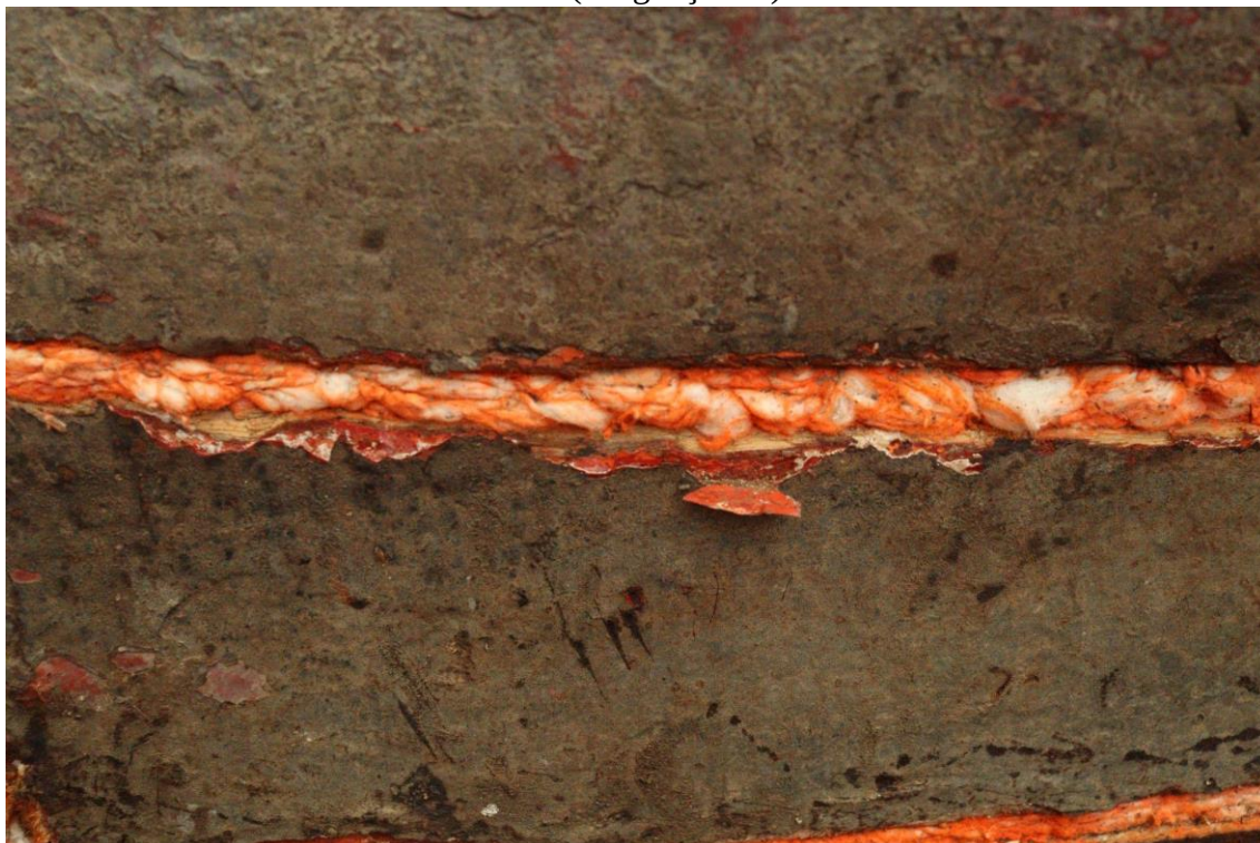
Figura 27. Algodão tingido com zarcão colocado nas “costuras” da embarcação (Bragança/PA).
