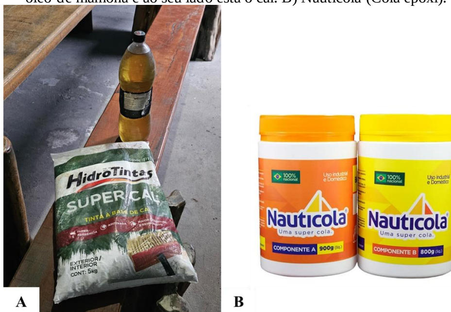
Figura 37. Materiais utilizados para preparar a massa da calafetagem. A) A garrafa contém óleo de mamona e ao seu lado está o cal. B) Nauticola (Cola epóxi).
