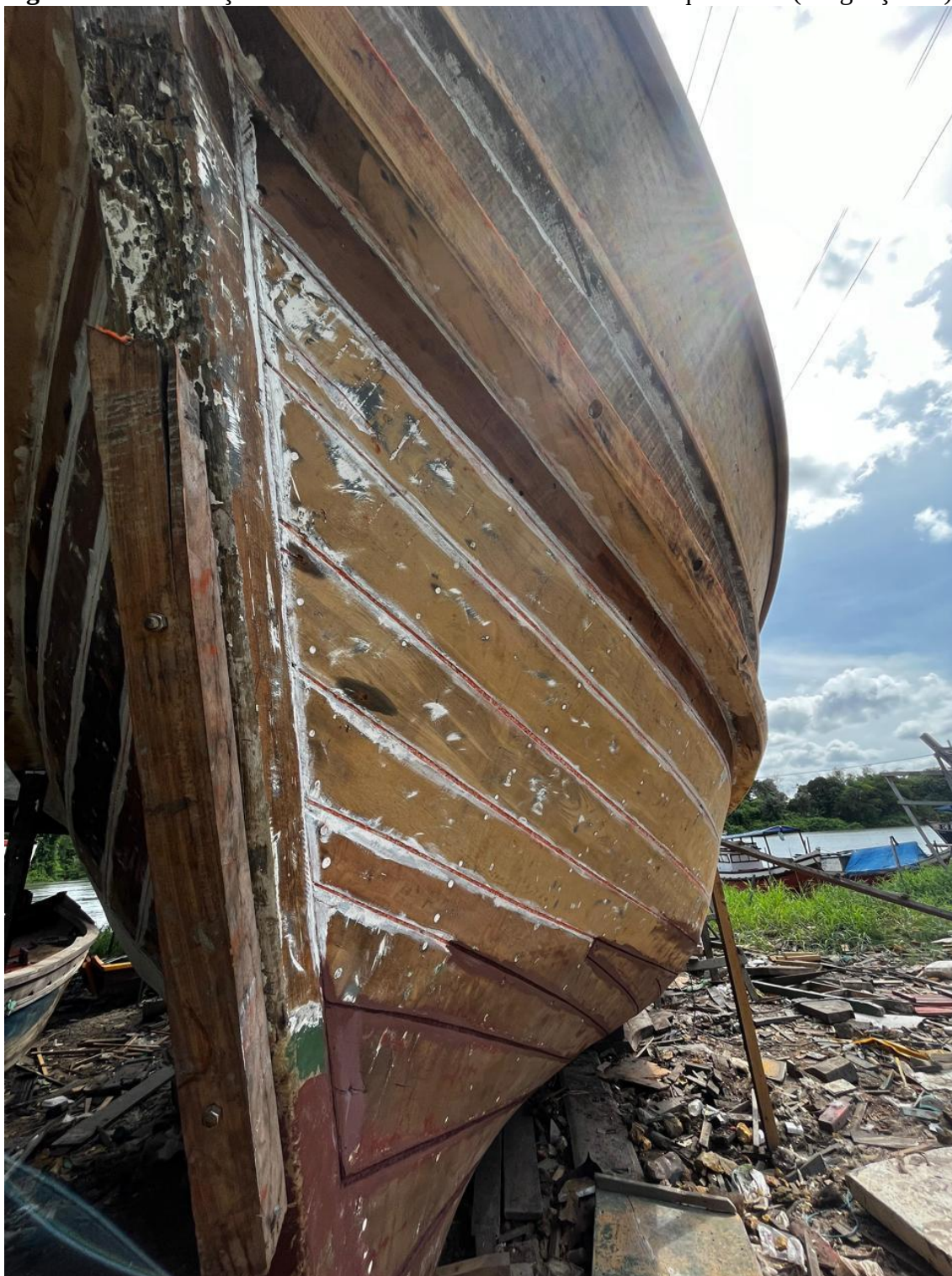
Figura 54. Embarcação nova sendo emassada. Estaleiro do Esquerdinha (Bragança/PA).
