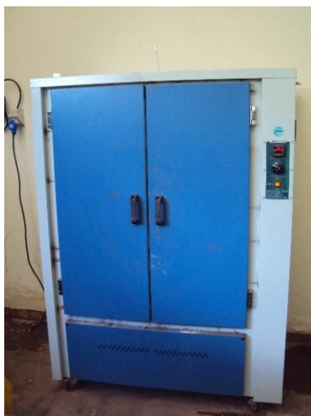
Fotografia 12- Estufa com recirculação de ar
