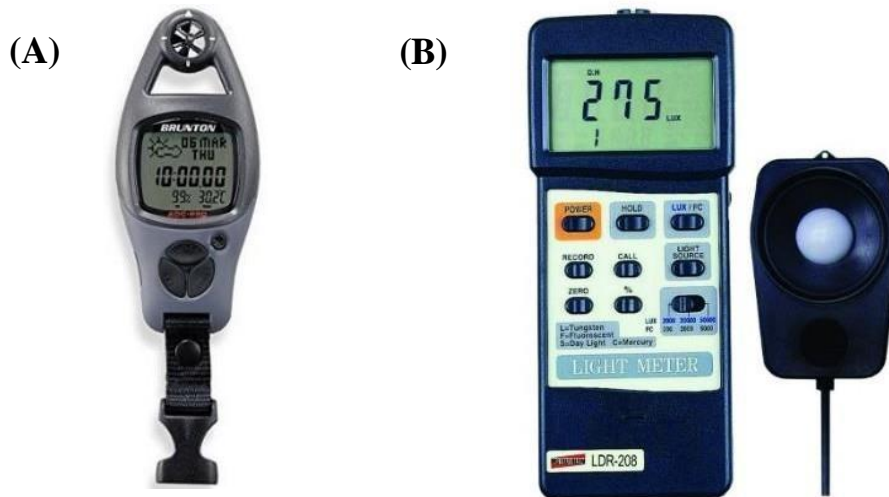
Figura 3. Instrumentos de coleta de parâmetros climatológicos. (A) Termohigrômetro digital (BRUNTON, Atmospheric data center, ADCTM). (B) Luxímetro - Medidor de Intensidade de Lux Digital Mod. LDR-208 - INSTRUTHERM®
