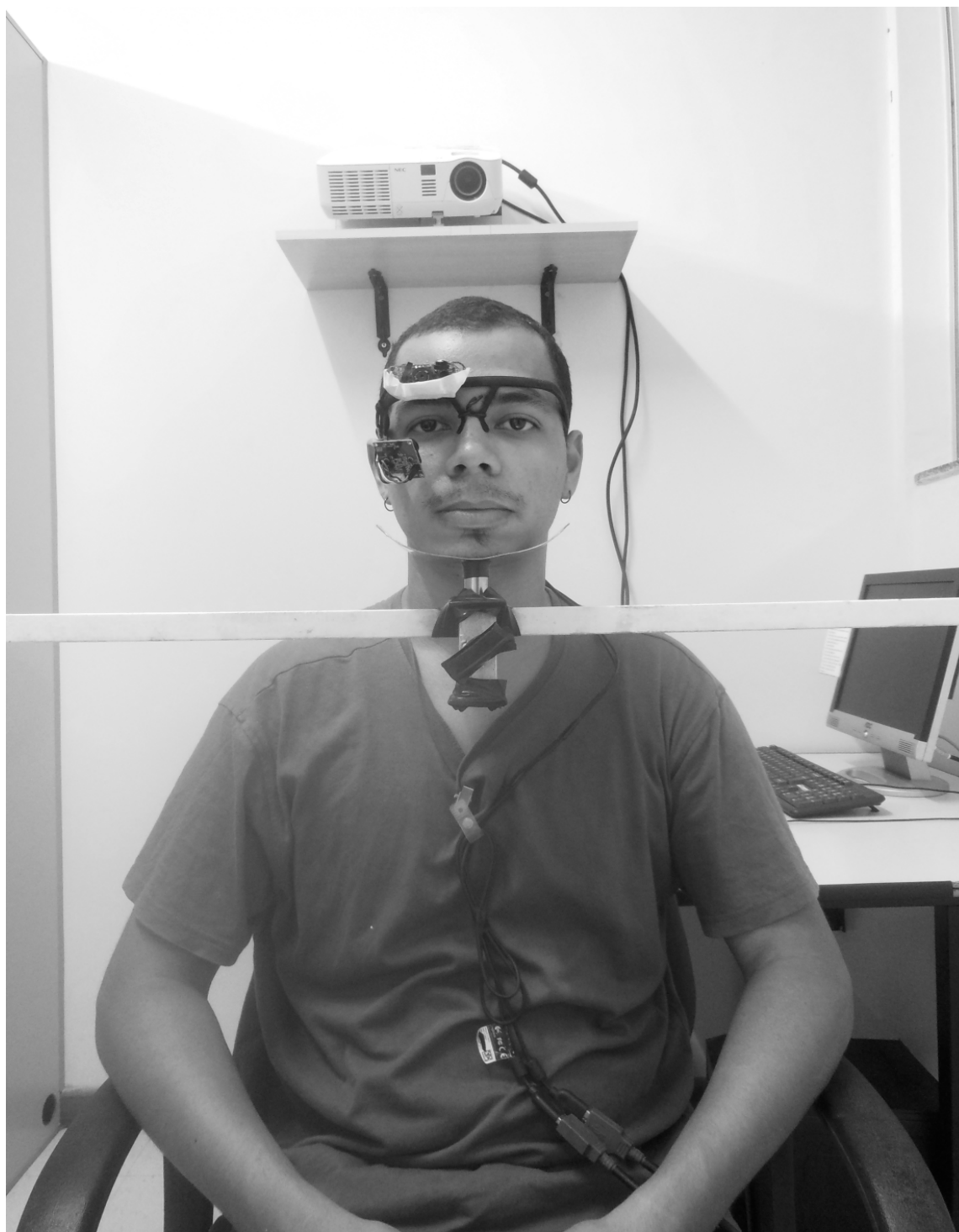
Figura 1. Equipamento usado nos estudos. Os equipamentos usados eram idênticos aos da figura, com exceção do tamanho da sala e de uma câmera do olho mais recente. A figura mostra a câmera do mundo, a câmera do olho, o suporte de cabeça (Pupil Dev), o clipe de sustentação dos cabos, o retroprojeto e o descanso para o queixo.
