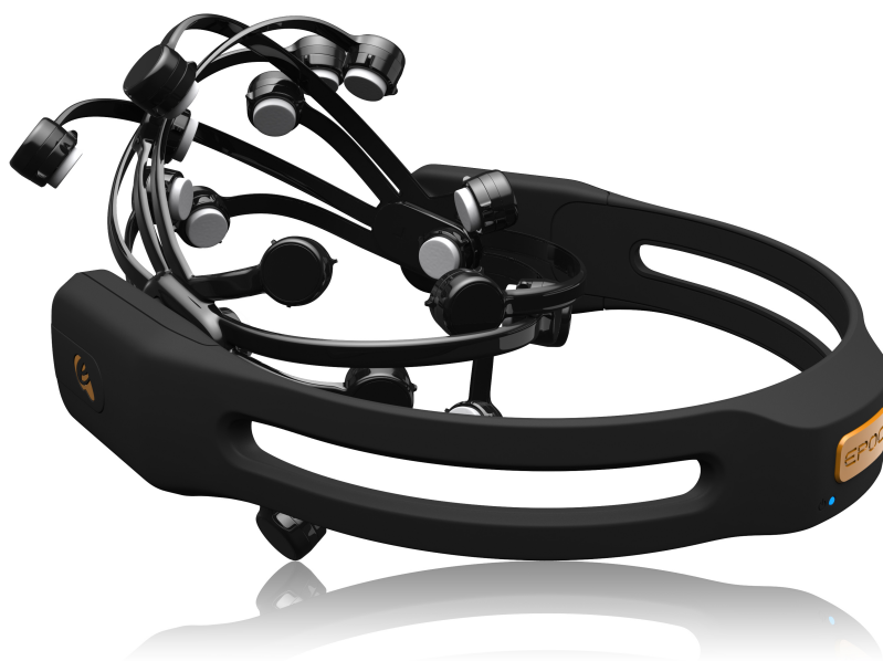
Figura 6 – EEG neuro-headset Emotiv EPOC , desenvolvido para aplicação em BCI, foi adquirido para realização dos registros de dados neste trabalho, dispondo de 14 canais e transmissão sem fio.
