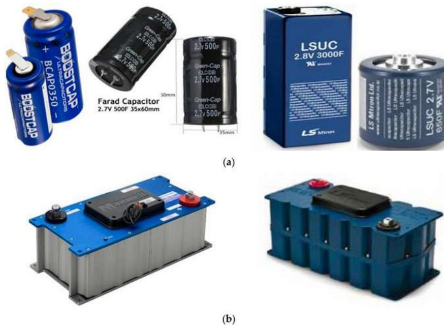
Figura 6 – (a) Diferentes tipos de dispositivos comerciais SC, (b) Módulos SC de duas empresas diferentes.
