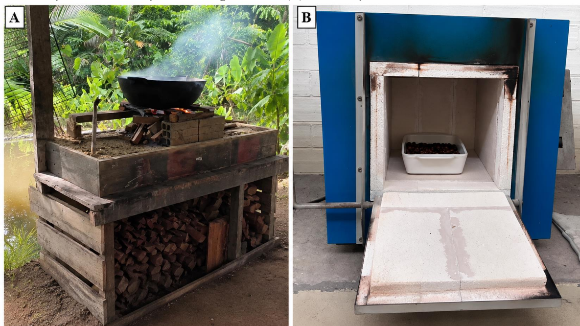
Figura 8 - Sistemas de carbonização utilizados na produção dos carvões ativados: (A) carbonização artesanal em panela metálica aquecida em fogão a lenha; (B) carbonização em mufla modelo MUF-4525
