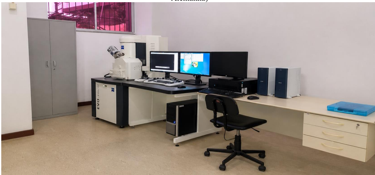
Figura 9 - Equipamentos utilizados na caracterização morfológica das amostras: (A) metalizador Quorum, modelo Q150T-ES; (B) microscópio eletrônico de varredura Zeiss, modelo EVO MA-10 (Carl Zeiss AG, Alemanha)
