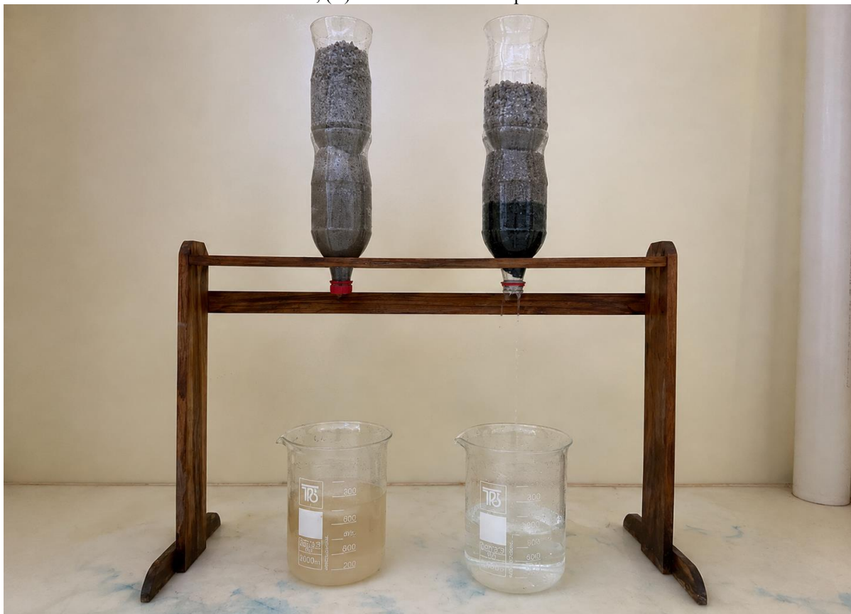
Figura 13 - Comparação visual da água obtida nos ensaios preliminares de filtração: (A) sistema filtrante sem a camada de carvão ativado; (B) sistema filtrante completo contendo carvão ativado
