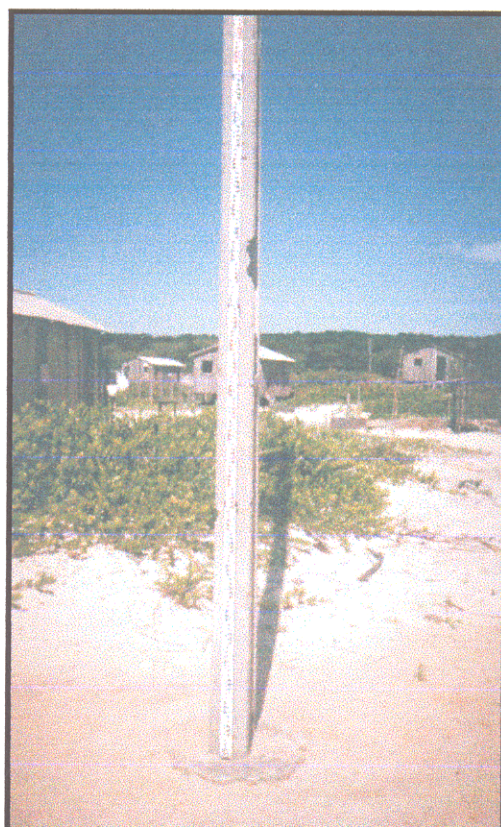
Figura 4 - Esquema da utilização dos postes de iluminação que ocorrem ao longo da praia de Ajuruteua. Os mesmos representam os pontos iniciais dos perfis.
