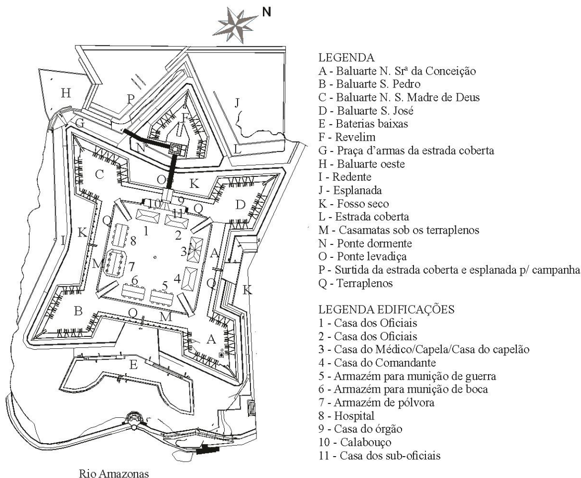
Figura 5. Identificação dos elementos de proteção e edificações intra e extramuralhas que compõem o complexo fortificado da FSJM
