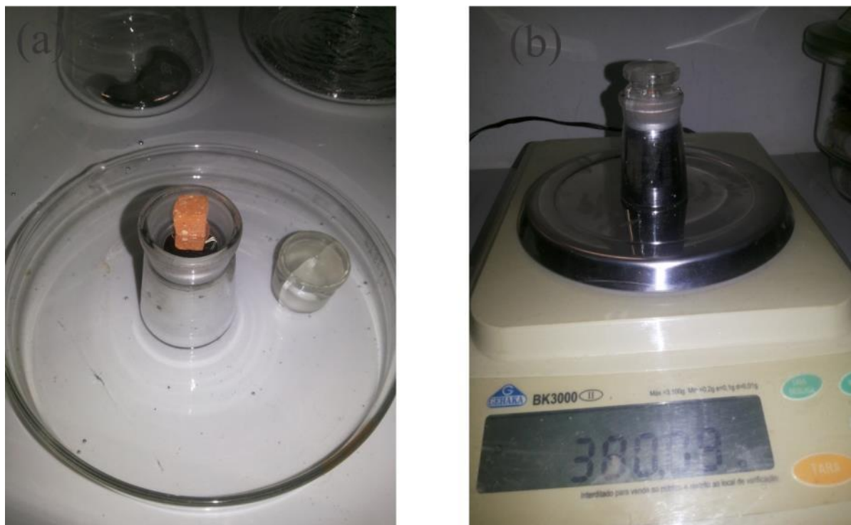
Figura 22. Etapas do ensaio para determinação da densidade em Hg pelo picnômetro de Hubbar
