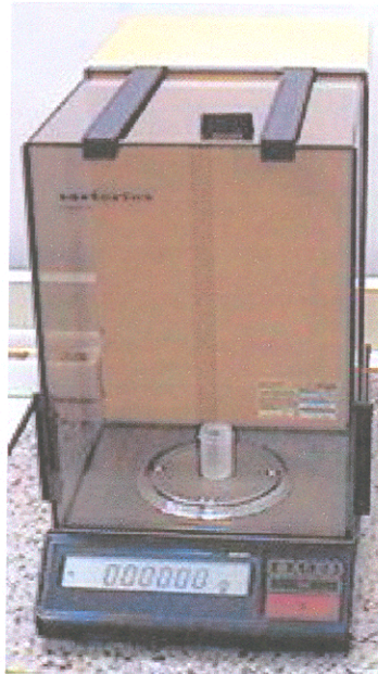
Figura 03 – Balança de precisão ( Sartorius ) utilizada para a pesagem das carapaças.
