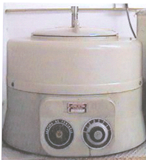
Figura 05 – Centrífuga ( Fanem ) utilizada no procedimento de decantação da solução da amostra.
