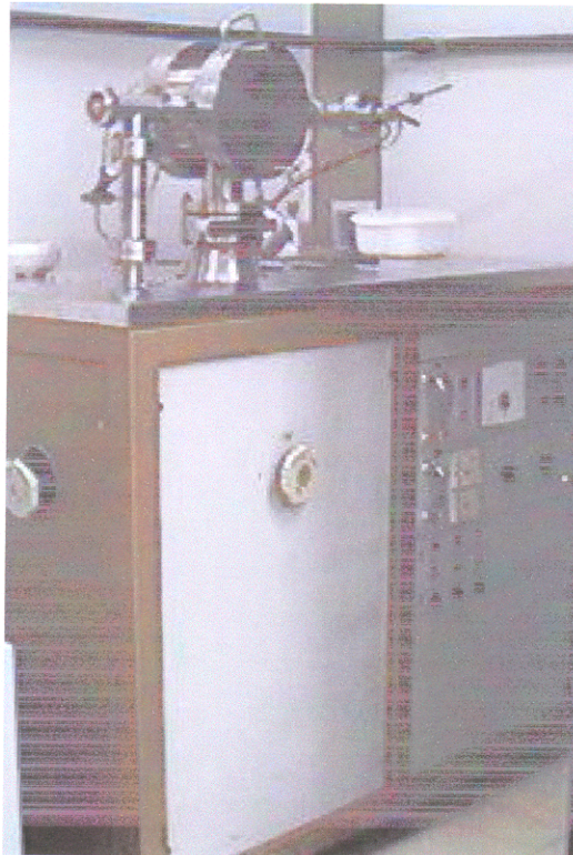
Figura 07 – Degaseficador utilizado na etapa de purificação dos filamentos.
