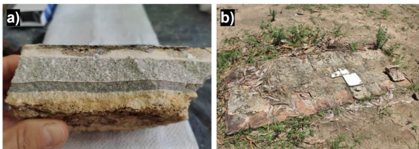
Figura 2: Exemplos da técnica multicamada e monocamada respectivamente: a) amostra retirada do mausoléu B43 (construído em 1870) com 3 camadas de argamassas diferentes; b) no túmulo B24 (construído possivelmente em meados do século. XIX) foi aplicada apenas uma camada de argamassa que desempenha as funções de preparar o substrato e assentar os azulejos.
