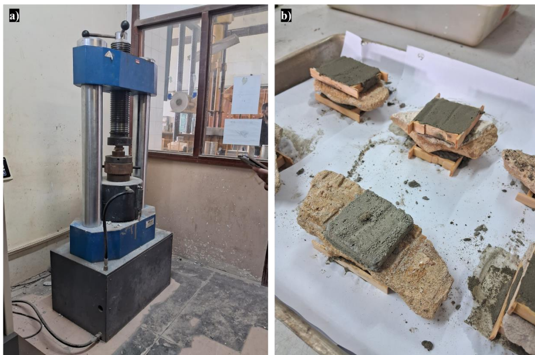
Figura 15 – a) prensa utilizada para o rompimento das amostras investigadas; b) argamassas de nivelamento em processo de cura.
