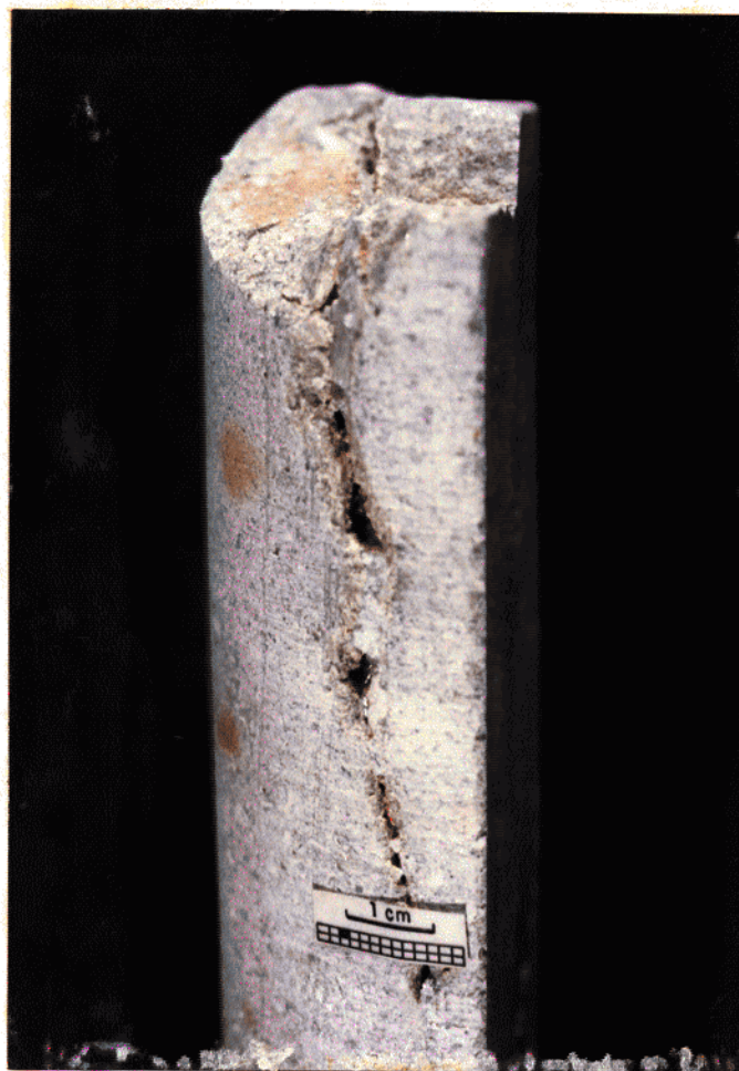
Fig. 4 - Fotografia do testemunho 1 do poço X, profundidade 3515 m, mostrando o aspecto da porosidade de fratura, parcialmente mineralizada, localmente alargada por lixiviação. Outras características são a subverticalidade e a descontinuidade.
