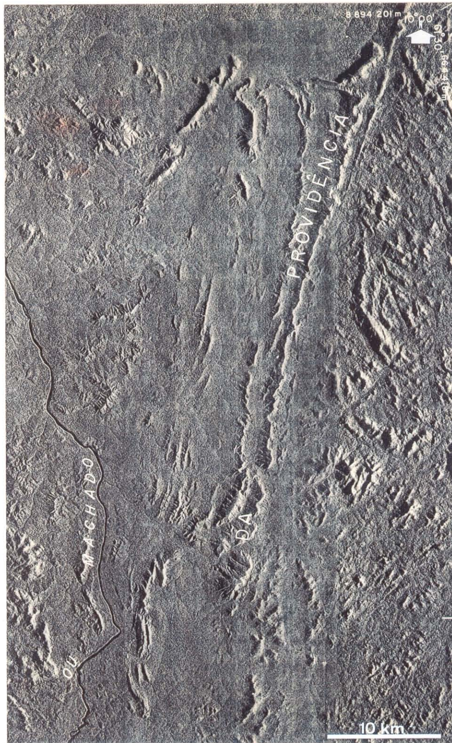
Figura 2.126 - Falha de Empurrão de Alto Ângulo. Serra da Providência (RO). Imagem RVL - GEMS, Banda X.
