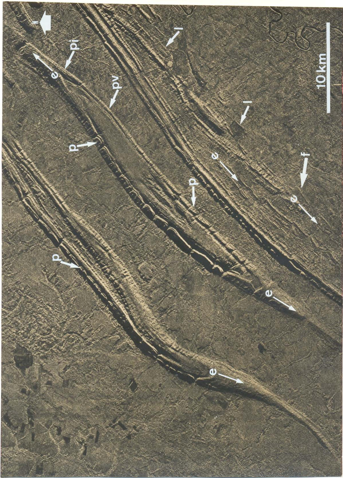
Figura 2.119 - Estruturas Dobradas em Metassedimentos de Baixo Grau. Serra do Tira Sentido (MT). Imagem RVL-GEMS, Banda X, 1975/1976. Folha SD.21-Z-A. l = estruturas lineares; p= estruturas planares invertidas; pv = estruturas planares invertidas; pi = eixo ; e = eixo ; f = falha. Vide explicações no texto .
