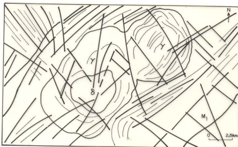
Figura 2.107 - Estrutura Circular. Corpo ígneo em Oito : básica e ácida. Folha SF.24-V-A. (Cf. Figura 2.104). Vide explicações no texto. Contato = ~ ~ ~ ; Feição planar = - - - ; Feição linear negativa = - - - ; Feição linear positiva = - - - ; Básica = δ ; Ácida = γ ; M 1 = rocha metamórfica
