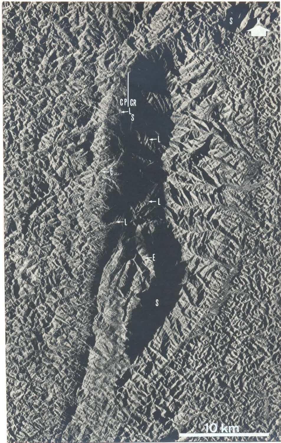
Figura 1.20 - Sombra de Radar, Encurtamento de Radar e “Layover” (?). Região da Serra do Caparaó.(MG/ES). Imagem RVL-GEMS, Banda X, 1975/1976. Folha SF.24-V-A. CP = canal próximo ; CR = canal remoto ; S = sombra ; L = pseudo “layover”. Vide explicações no texto.
