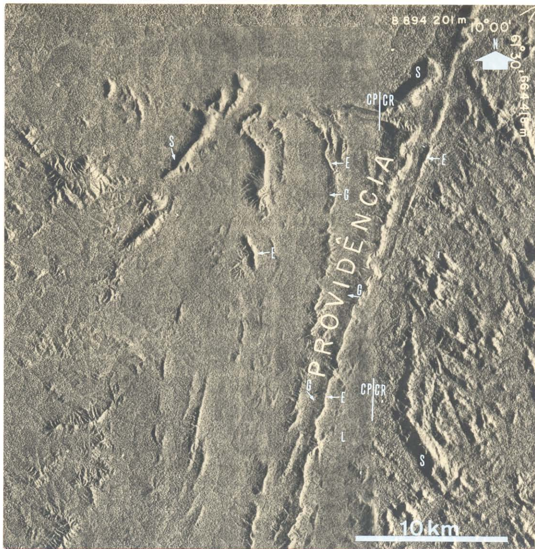
Figura 1.18 - Sombra de Radar, Encurtamento de Radar e “Grazing”. Região da Serra da Providência (RO). Imagem RVL-GEMS, Banda X, 1971/1972. Folha SC.20-Z-A. CP = canal próximo ; CR = canal remoto ; G = “grazing” ; S = sombra ; E = encurtamento de pendentes. Vide explicações no texto.
