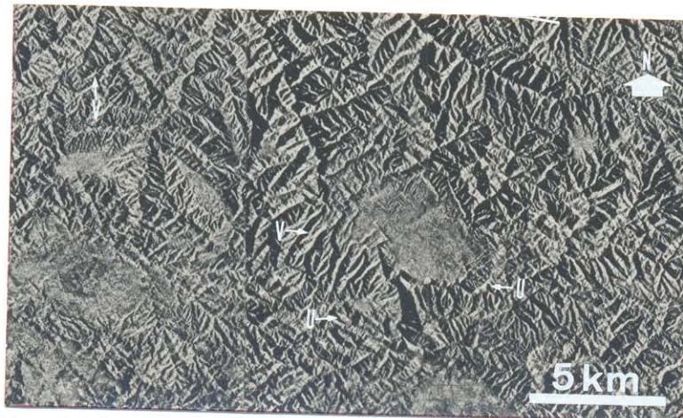
Figura 2.63 - Feições Planares Secundárias. Imagem RVL-GEMS, Banda X, 1975/1976. Folha SD.23-Y-C. V= superfície em forma de "V"; U = superfície em forma de "U".
