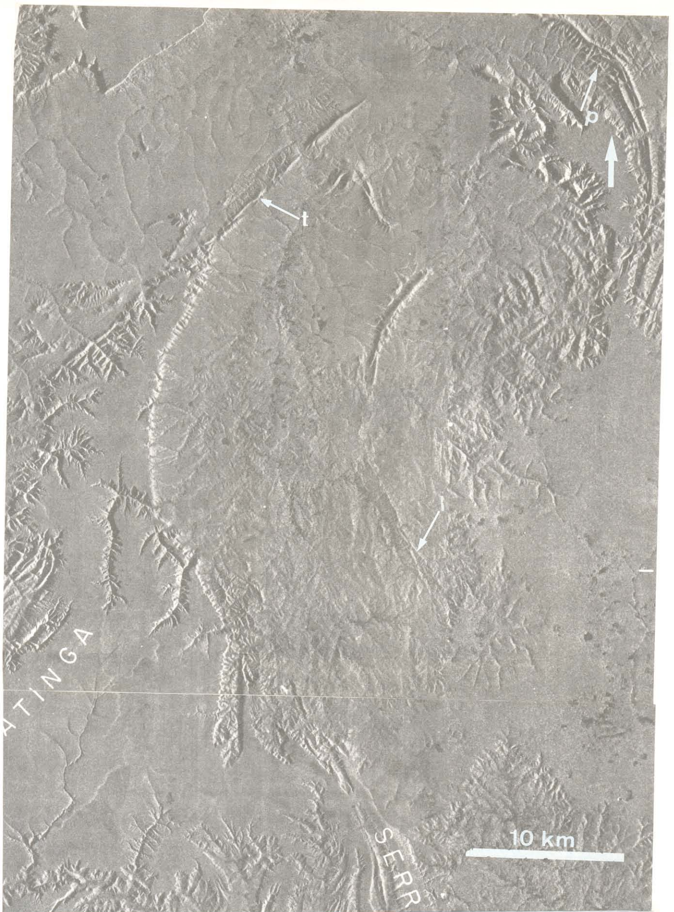
Figura 3.9 - Interseção de Cinturões de Cisalhamento. Serra da Tabatinga. Norte da Bahia. Imagem RVL/GEMS. 1971/1972. Banda X. Porção sul do embasamento da sinéclise. Feições lineares (l), planares (p) e tabulares (t) configuram um modelo de interferência tipo Laço.
