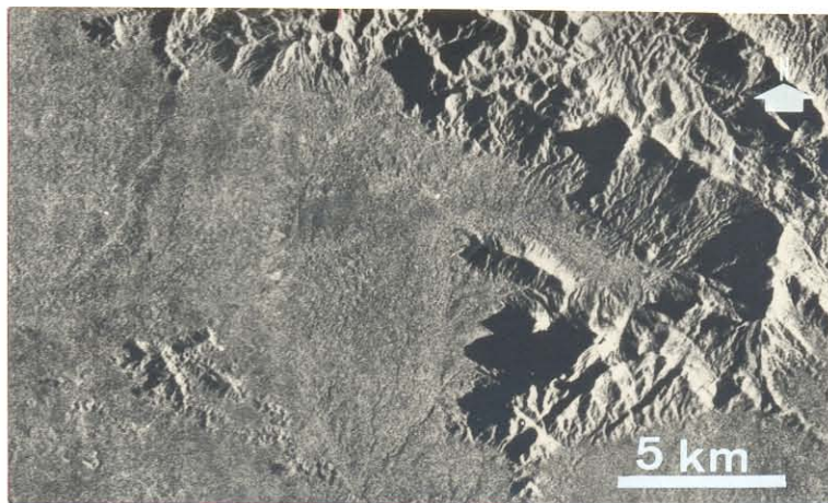
Figura 2.34 - Padrões de Drenagem Distributário e Retangular. Imagem RVL-GEMS, Banda X, 1971/1972. Folha NA.19-Z-D.
