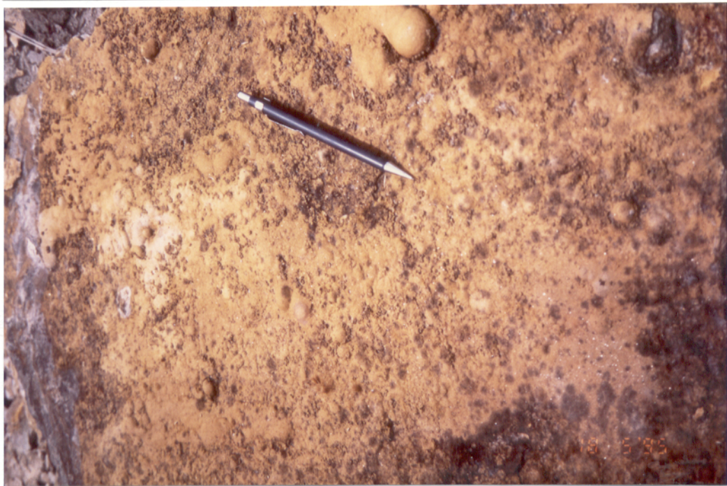
Figura 15 - Lentes da fácies Alp mostrando concreções de óxido de ferro.
