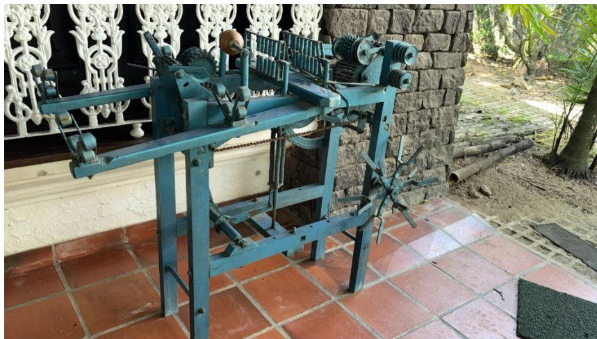
Figura 22: Máquina de prensar tabaco desenvolvida pelo imigrante espanhol Cirilo Colino
