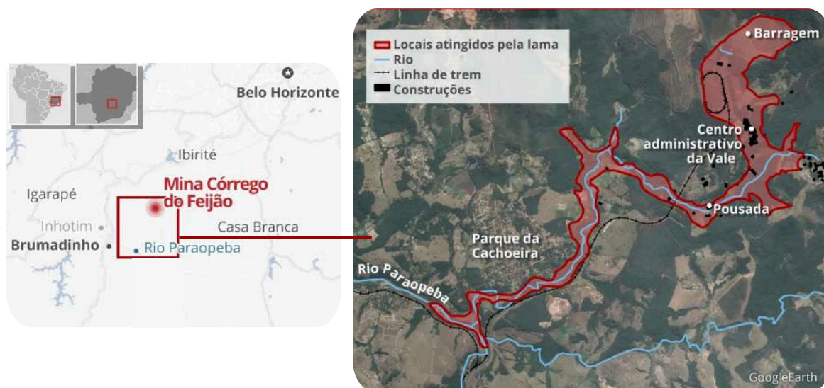
Figura 2 – O caminho percorrido pela lama após o rompimento da Barragem 1 da Mina do Córrego do Feijão, em Brumadinho/MG.
