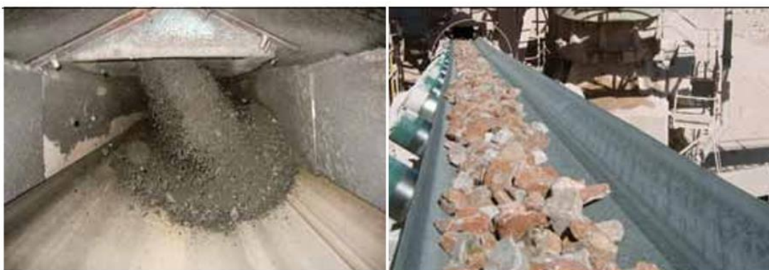
Figura 2.10 - Carregamento fora de material fora de centro. Fonte: Adaptado de Swinderman et al. , 2009.
