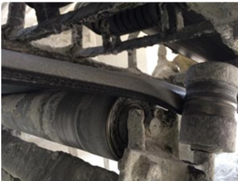
Figura 2.15 - Contato correia e rolete guia.
