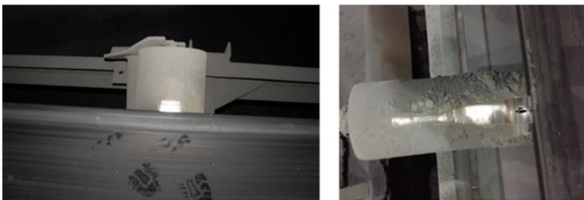
Figura 2.8 - (a) traços de fricção da correia no rolete bloqueado (desgaste por fricção do tubo); (b) danos ao tubo devido ao bloqueio do rolamento Fonte: Nortnowski et al. , 2022.
