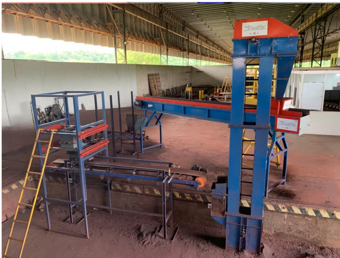
Figura 3.6 - Circuito de manuseio de minério. Fonte: Elaboração própria.
