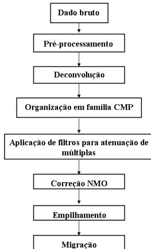
Figura 4.1: Fluxograma com as principais etapas do processamento sísmico aplicado aos dados do Camamu.
