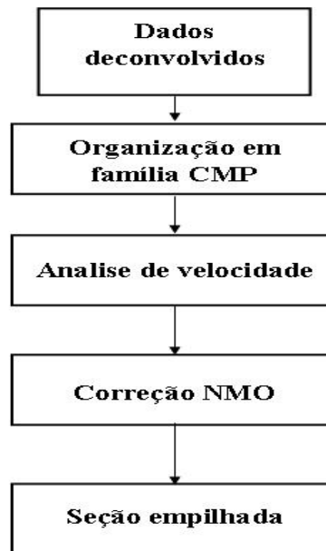
Figura 4.31: Fluxo do processamento aplicado aos dados do Camamu, depois da deconvolução até o empilhamento. Neste fluxo o único tratamento aplicado para a atenuação de múltiplas é o empilhamento CMP.
