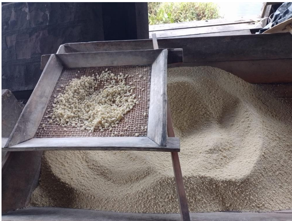
Figura 27 – Última peneiração para retenção de resíduos impróprios antes do ensacamento.
