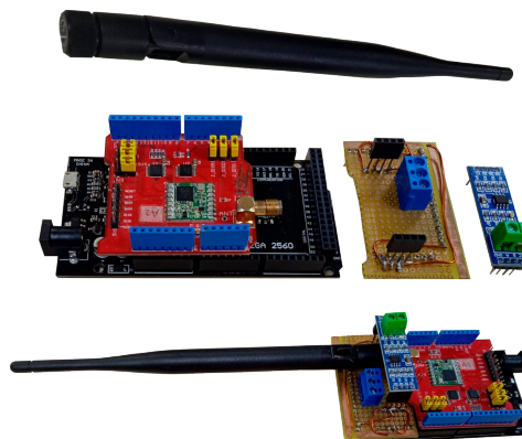
Figura 61 – Transmissor do Sistema Fotovoltáico
