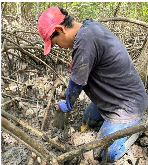
Figura 3. Procedimento de coleta da macrofauna com amostrador cilíndrico (10 cm de diâmetro) na Ilha de Algodoal-Maiandeuá, Costa Amazônica do Brasil. Fonte: Autora, 2023.
