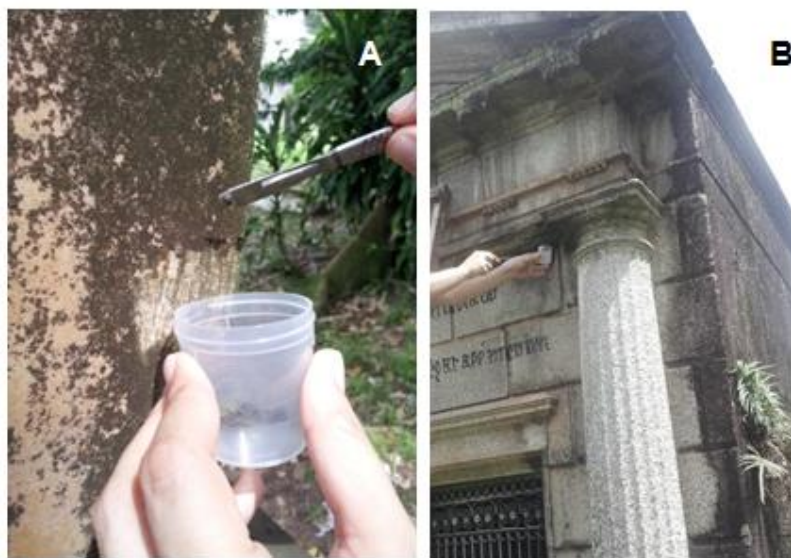
Figura 32: Coleta de material de origem: A) biológica no túmulo F42 e B) inorgânica no mausoléu F31.
