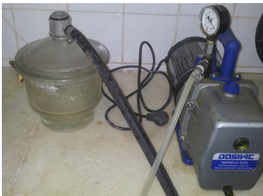
Figura 37: Amostras submersas em água em recipiente acoplado à bomba de vácuo.
