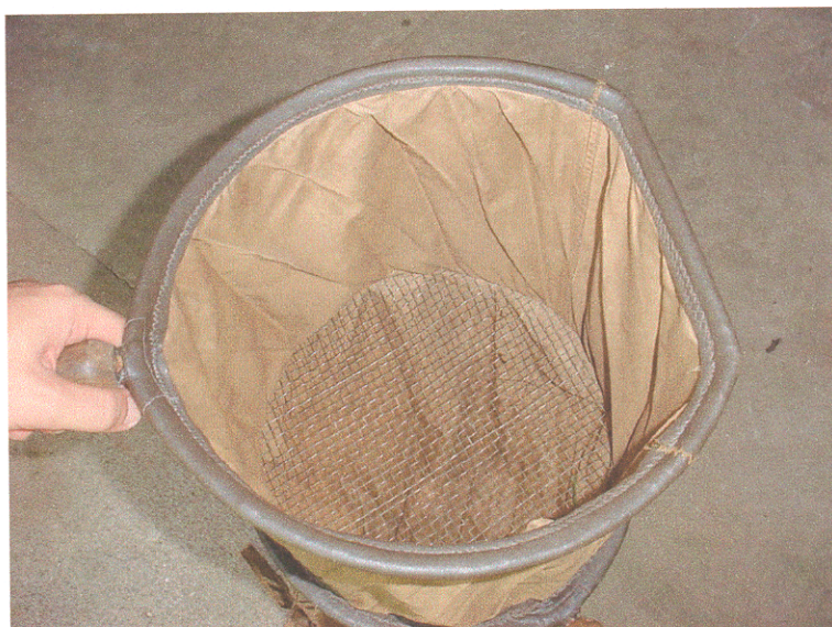
Figura 9. Concentrador de serapilheira utilizado na amostragem da mesofauna de aranhas da ECFP, Caxiuanã. Foto: A. L. Prudente.
