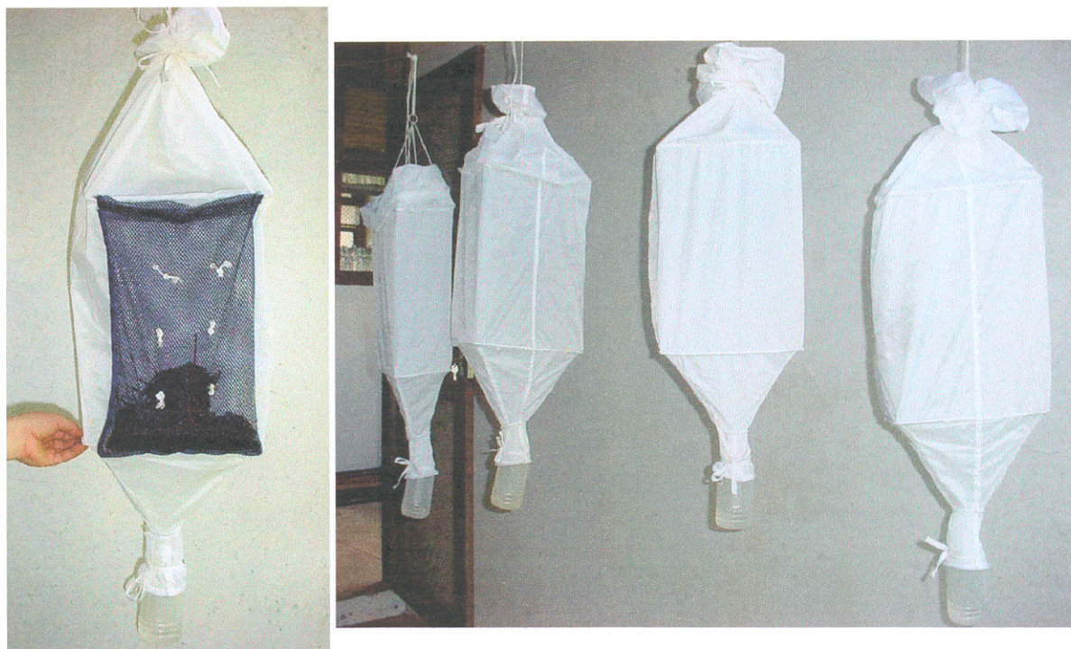
Figura 11. Extratores de Winkler utilizados na amostragem da fauna de aranhas de serapilheira na ECFP, Caxiuanã. Esquerda: rede de contenção parcialmente cheia com serapilheira; Direita: extratores instalados. Fotos: A. L. Prudente.
