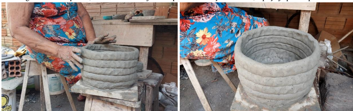
Figura 62: À esquerda, Dona Marciana ajusta os pavios da loiça. À direita, a peça já pronta para secar
