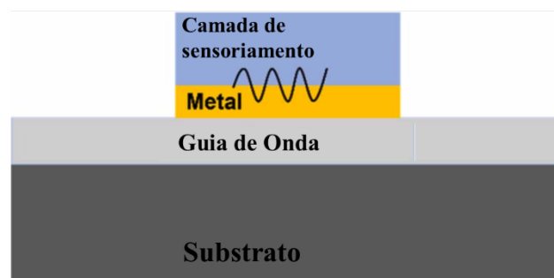
Figura 2.6 - Diagrama esquemático de um sensor SPR de guia de onda óptico integrado.
