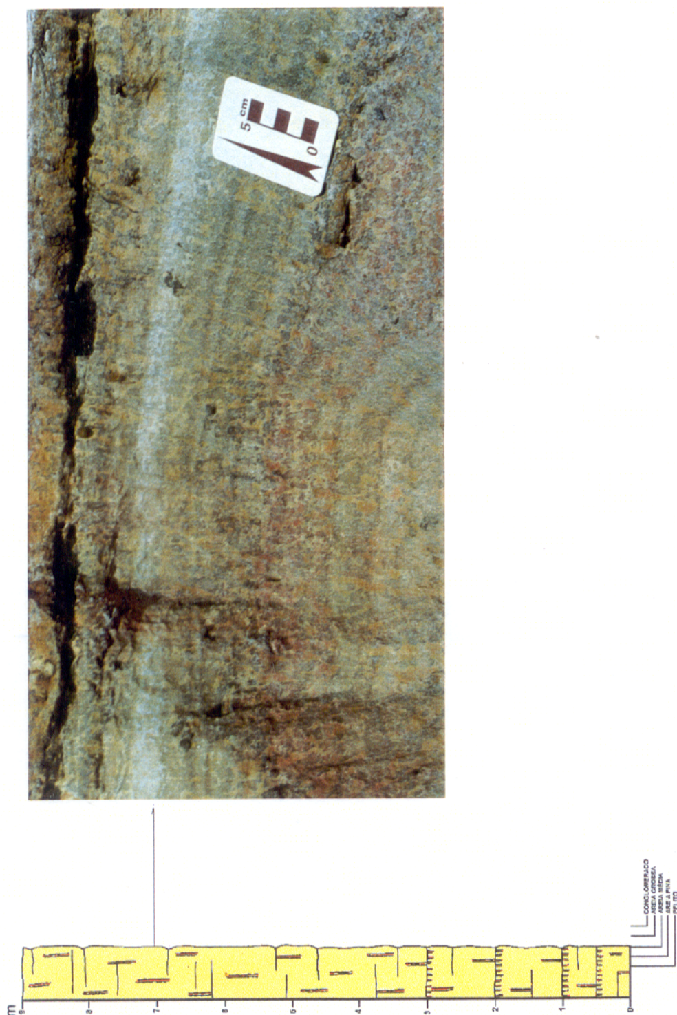
Figura 19 - Perfil estratigráfico no km-15 da BR-174 mostrando sucessão de camadas de arenito bioturbado com estratificação plano-paralela discreta ( fácies Am).
