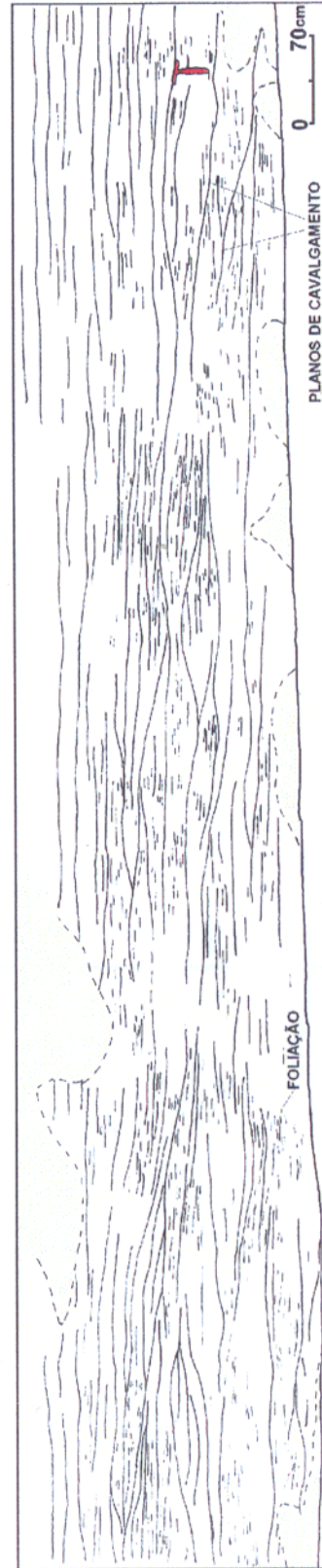
Figura 45 - Disposição subhorizontal das estruturas. Observar que os planos de cavalgamento truncam os planos de foliação Ev = Eh
