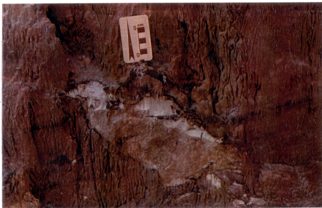
Figura 51 - Fragmentos irregulares de diamictito dento do Arenito foliado. Observar ferruginização nos contatos.
