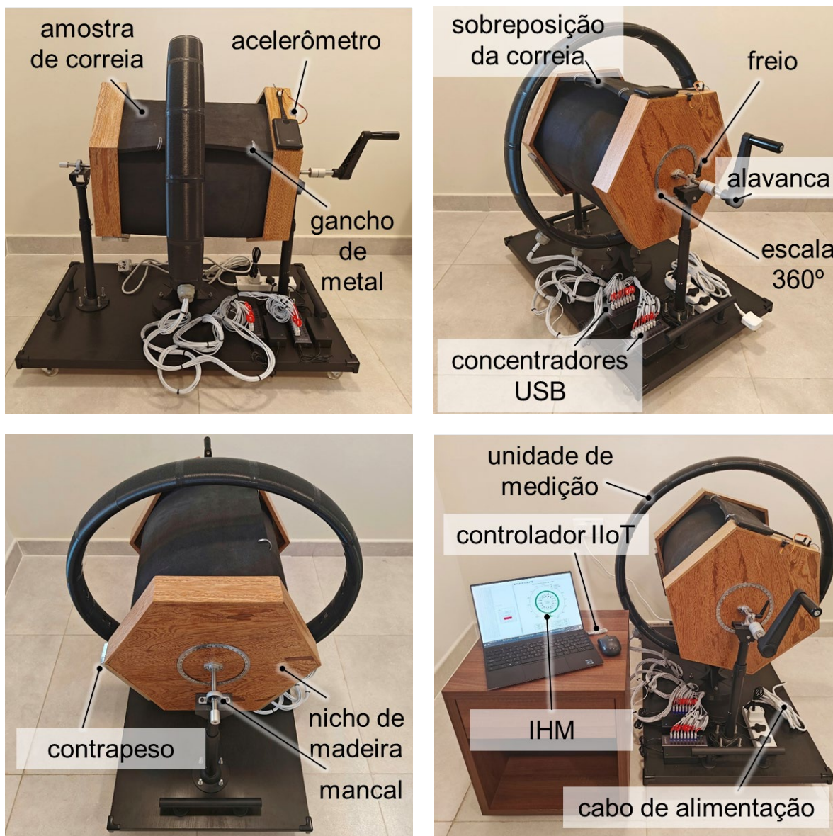
Figura 30. Bancada de testes e seus principais componentes [36].
