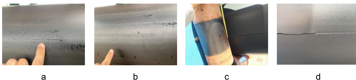
Figura 5. Propagação de trincas em correias transportadoras tubulares. (a, b) Película fina oxidada na superfície da cobertura de retorno; (c, d) Crescimento e nucleação de fissuras [5].
