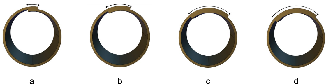
Figura 10. Relação B/D em diferentes comprimentos de sobreposição para diâmetro nominal de 375 mm. (a) relação B/D igual a 3,6; (b) relação B/D igual a 3,8; (c) relação B/D igual a 4,0; (d) relação B/D igual a 4,2 [5].
