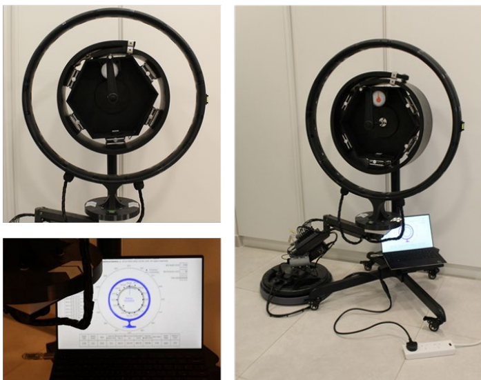
Figura 55. Sistema multiparâmetro avançado para monitoramento da rotação da correia em transportadores tubulares. A IHM é exibida em tamanho e resolução reduzidos para fins de visualização geral [59].
