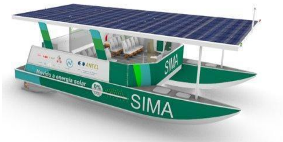
Figura 9 - Barco de propulsão elétrica, com captação de energia fotovoltaica, modelo catamarã.
