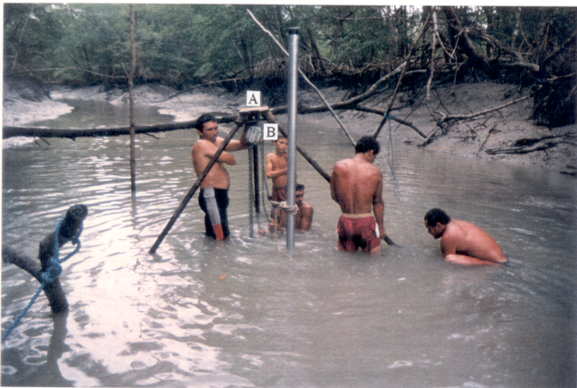
Figura 3.2 - Recuperação de testemunhos utilizando-se uma (A) torre de ferro galvanizado e (B) uma talha (Testemunho T-19).
