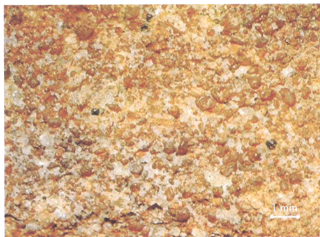
Figura 50 - Visão mesoscópica de textura da fácies fluvial, realçando a polimodalidade granulométrica da fase detrítica.
