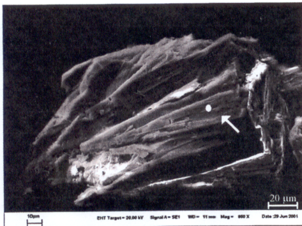
Figura 61 - Micrografia (MEV) realçando o caráter prismático de cristais de laumontita e a tendência a formar agregados fibrorradiais (amostra NR-A-16).
