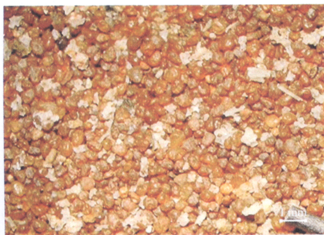
Figura 51 - Grãos desagregados de arenito da fácies eólica, destacando o elevado grau de seleção e arredondamento da fase detrítica (acaramelada). Em branco, fragmentos de cimento zeolítico.
