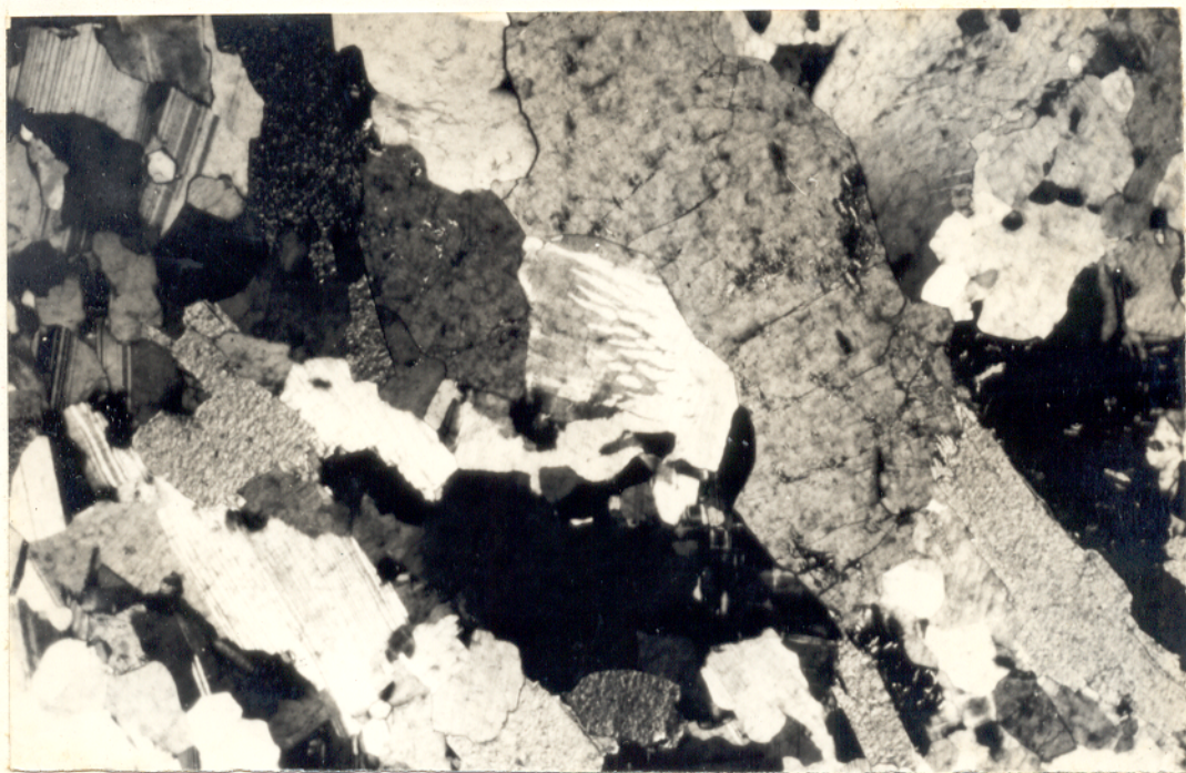
Fig. 36 - Fotomicrografia. Mesopertita onde uma parte de cristal é formada pela fase sódica, e a outra pela potássica. NX, 40X.
