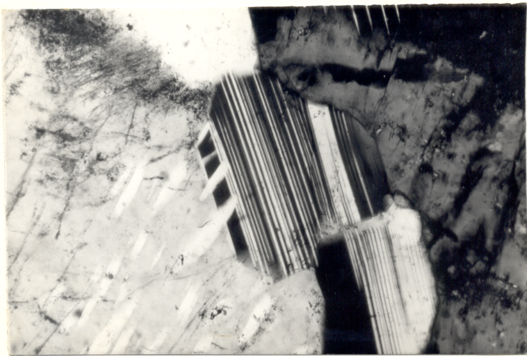
Fig. 35 - Fotomicrografia. Lamelas da fase sódica (peristerita) da mesopertita interpenetrante em cristal de peristerita. NX, 160X.
