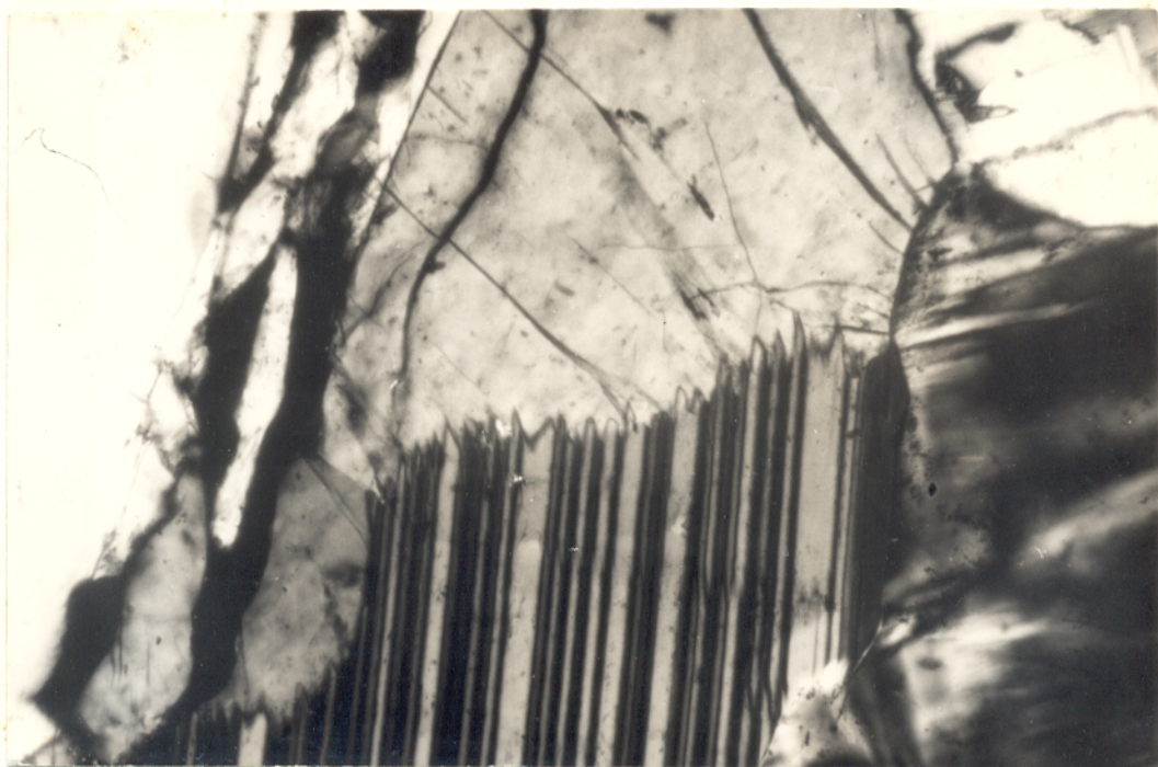
Fig. 26 - Fotomicrografia. Contato interpenetrante entre peristerita e nefelina normal. NX, 160X.
