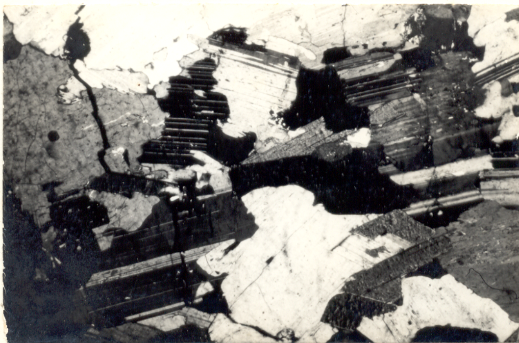
Fig. 18 - Fotomicrografia. Textura granoblástica, do nefelina sienito gnaiss, mostrando contatos interpenetrantes entre cristais de peristerita e entre peristerita e nefelina. NX 40X.
