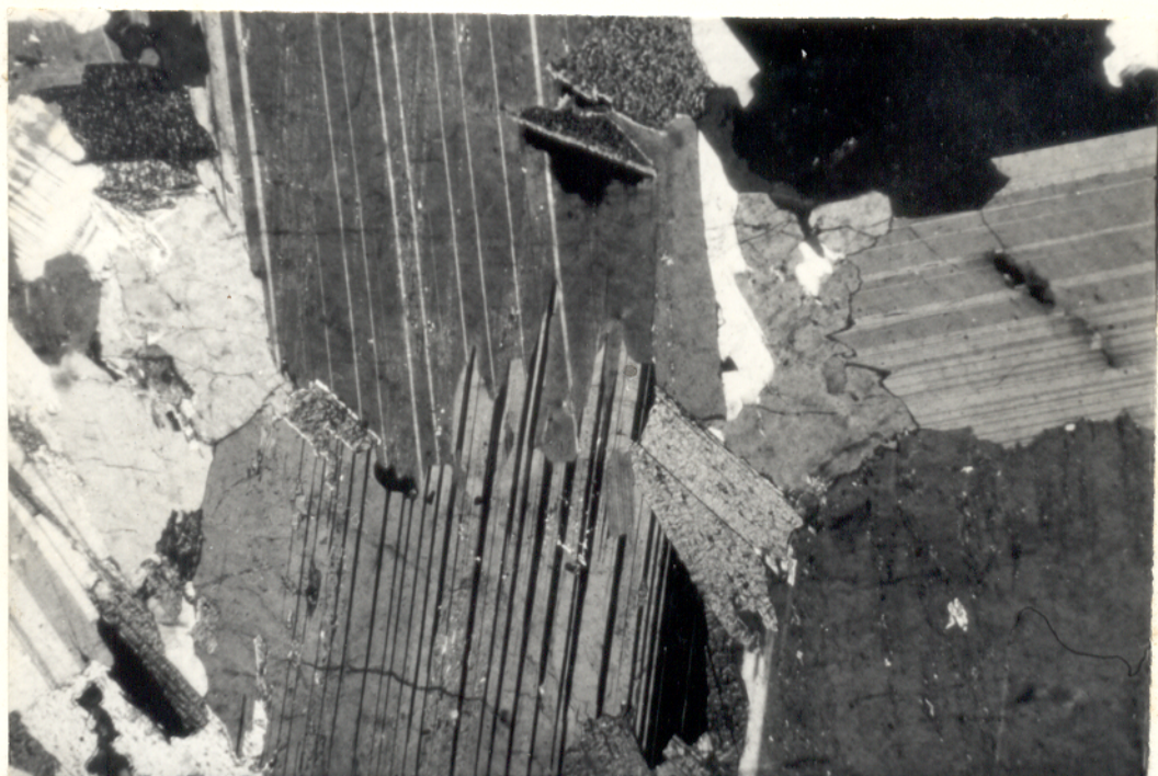
Fig. 45 - Fotomicrografia. Contato interpenetrante entre cristais de peristerita. NX, 40X.
