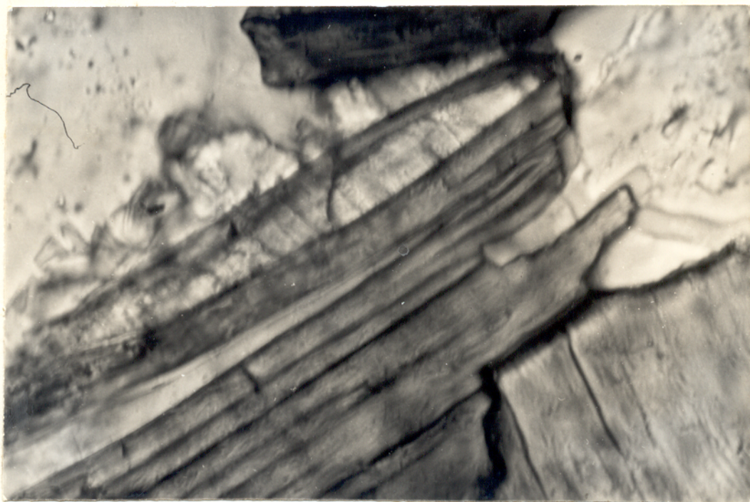
Fig. 53 - Fotomicrografia. Calcita e zeólita dispostas nos planos de clivagem da biotita. NX, 640X.
