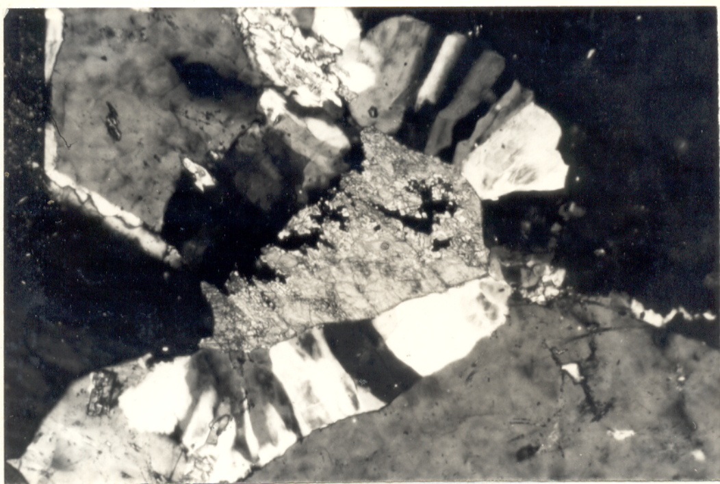
Fig. 27 - Fotomicrografia. Borda de cancrinita no contato da calci ta com a nefelina. NX, 160X.
