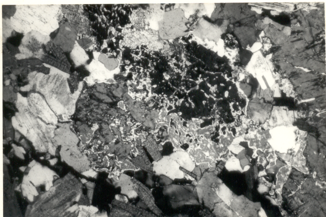
Fig. 55 - Fotomicrografia. Cancrinita invadindo irregularmente cristais de nefelina e peristerita. NX, 40X.
