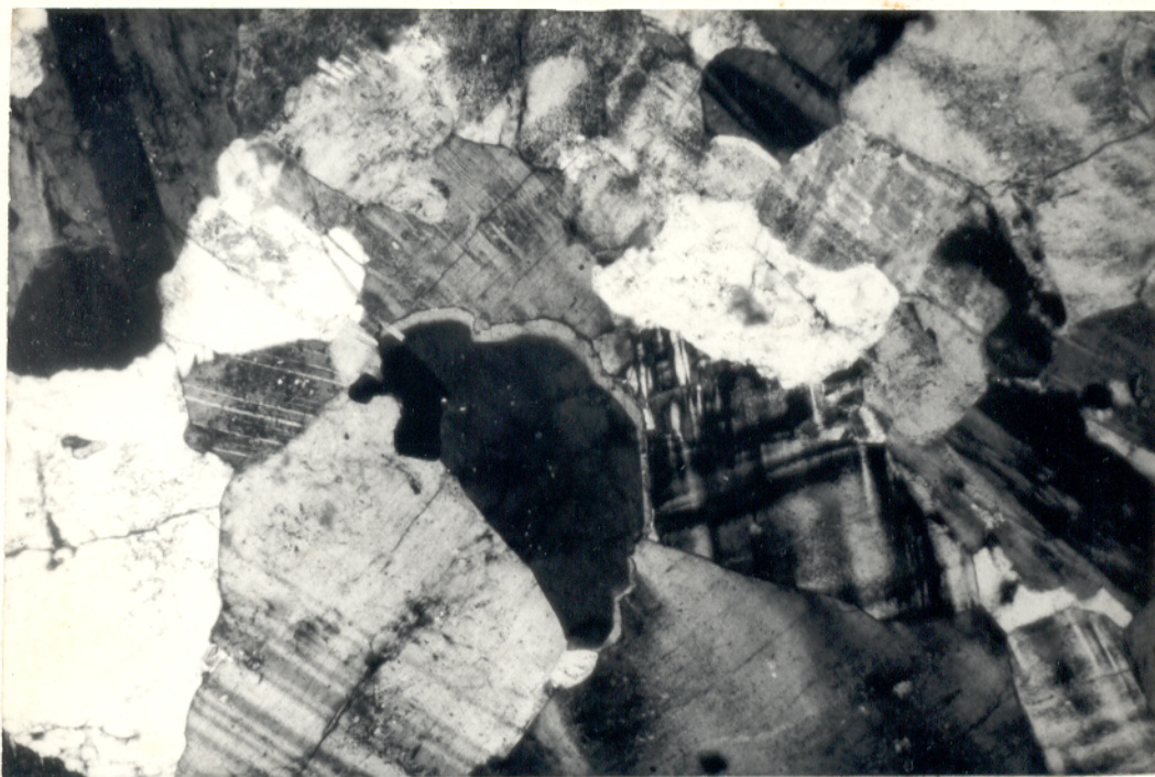
Fig. 15 - Fotomicrografia. Borda de albita no plagioclásio (em contato com cristais de microclina) mostrando passagem brusca do plagioclásio An_{8-14} para a borda de albita ( An_{0-3} ). NX, 40X.
