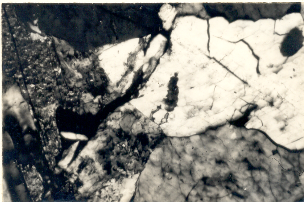
Fig. 57 - Fotomicrografia. Zeólita invadindo irregularmente os cristais de peristerita e nefelina. NX, 160X.
