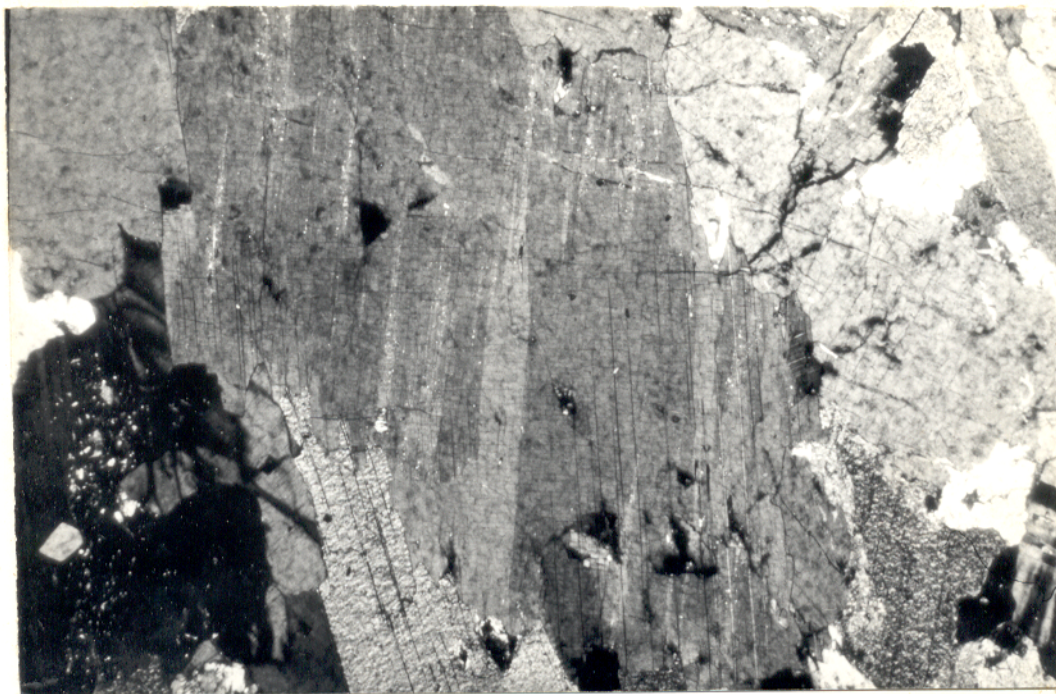
Fig. 41 - Fotomicrografia. Peristerita ( An_{7,0-10,7} - An_{0,4-4,0} ) apresentando as lamelas da fase mais sódica orientadas segundo os planos (081) e (010) na fase menos sódica. NX, 40X.
