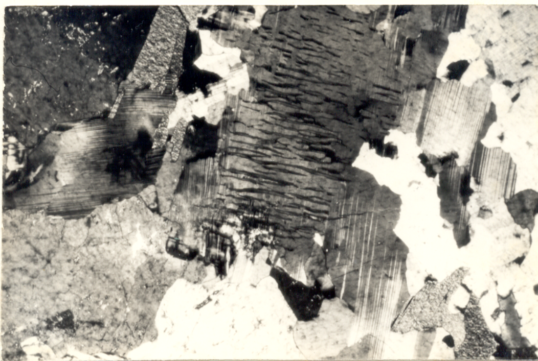
Fig. 33 - Fotomicrografia. Cristal de mesopertita com lamelas (fase potássica) tipo "string", "rod" e "bend". Extremidade norte do Maciço. NX, 40X.
