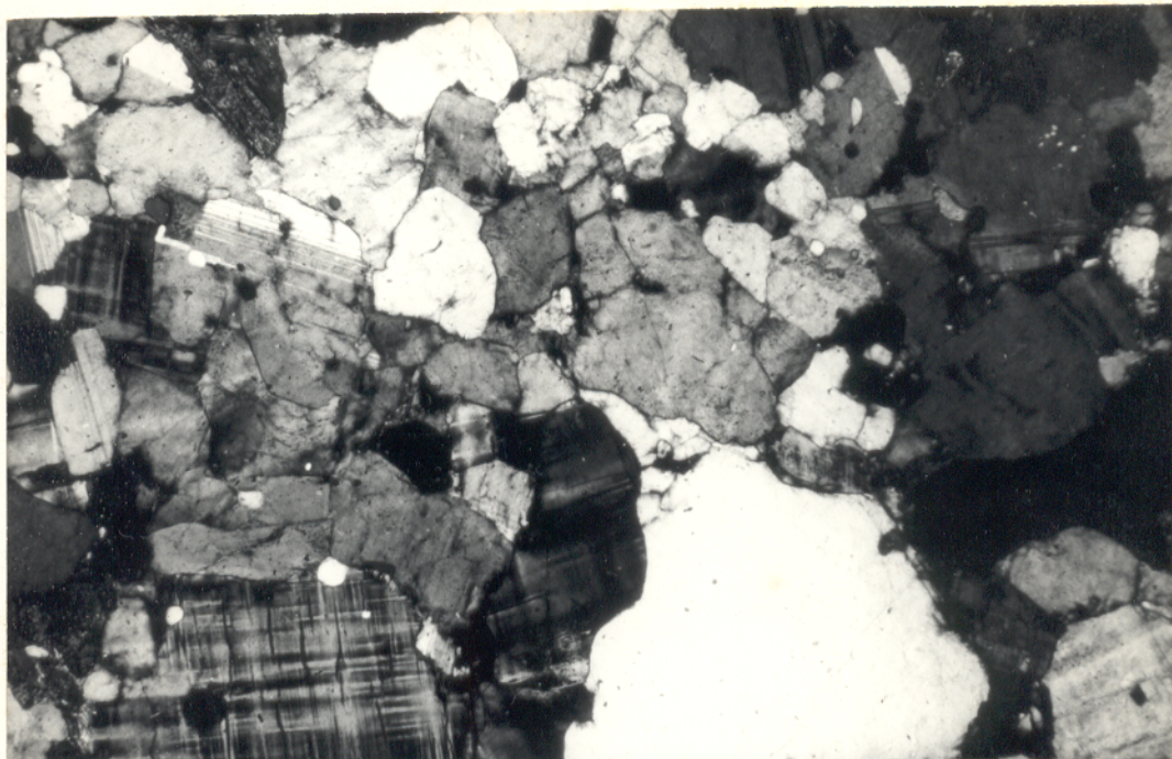
Fig. 13 - Fotomicrografia. Textura granoblástica, no granito gnaise, mostrando contatos curvos e/ou irregulares entre cristais de quartzo, microclina e plagioclásio. NX, 40X.
