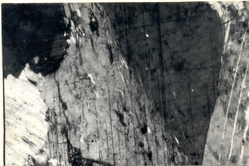
Fig. 43 - Fotomicrografia. Peristerita ( An_{7,0-10,7} - An_{0,4-4,0} ) onde uma parte do cristal é formada pela fase mais sódica (clara) e a outra pela menos sódica (escura). Esta última mostrando estriações segundo (081). Nx, 160X.
