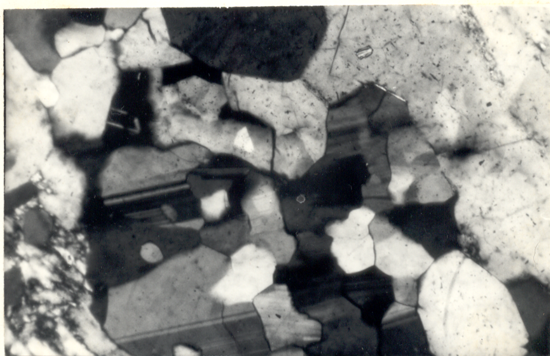
Fig. 12 - Fotomicrografia . Contato em ponto tríplice entre cris tais de albita intersticial. NX, 160 X.
