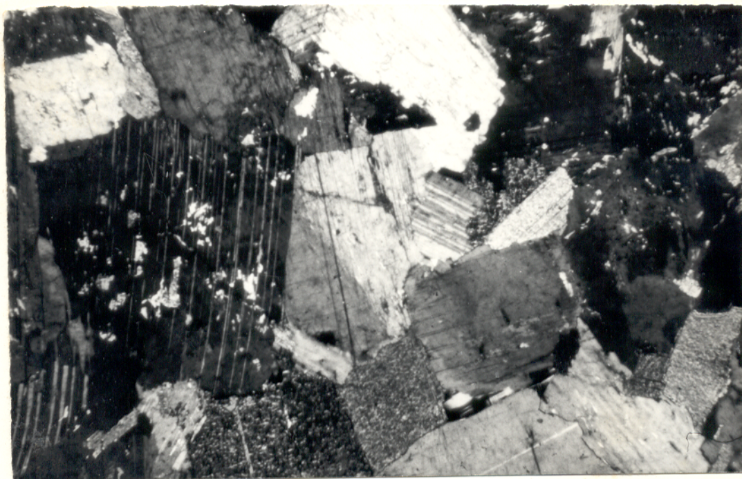
Fig. 44 - Fotomicrografia. Peristerita ( An_{4,0-5,1} - An_{0,5-2,8} ) onde uma parte do cristal é formada pela fase mais sódica (clara) e a outra pela menos sódica (escura), com o maclamento aparecendo nas duas fases. NX, 40X.
