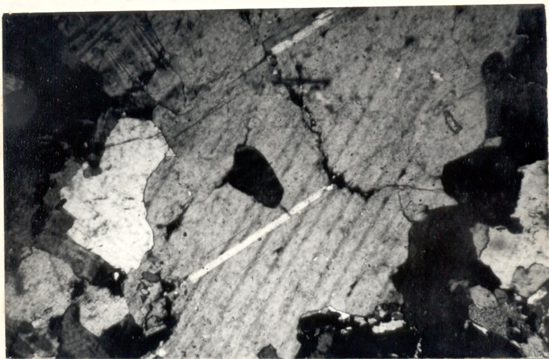
Fig. 39 - Fotomicrografia. Peristerita mostrando maclamento de deformação cortando o maclamento original. NX, 40X.
