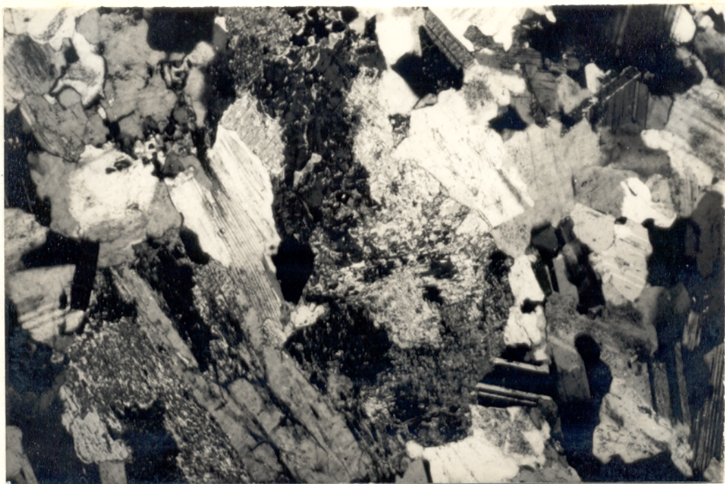
Fig. 51 - Fotomicrografia. Agregados de muscovita e cancrinita substituindo parcial a totalmente cristais de nefelina. NX, 40X.
