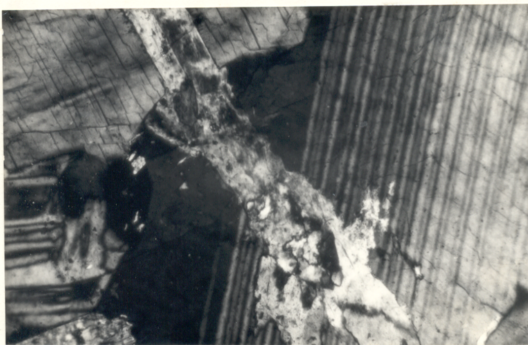
Fig. 56 - Fotomicrografia. Zeólita preenchendo fratura no nefelina sienito gnaiss. NX, 160X.
