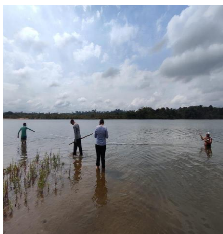
Figura 3: Pesquisadores e colaboradores realizando a batimetria do canal principal do rio Xingu.
