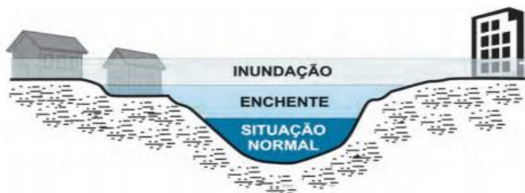
Figura 3 – Perfil esquemático do processo de enchente e inundação.
