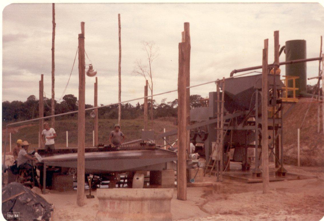
Fig. 13 - Explotação mecanizada de ouro nas cabeceiras do Igarapé Paca pela Empresa Mineração das Onças nos cascalhos derivados dos conglomerados Camiranga.
