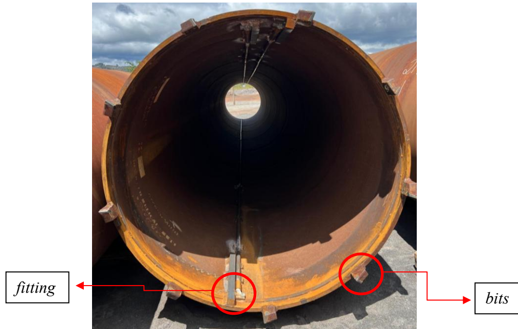
Figura 11– Estacas tubular com brocas metálicas soldadas (coroas), dotadas de elementos cortantes ( bits ) e sistema de jateamento de água ( fitting ).
