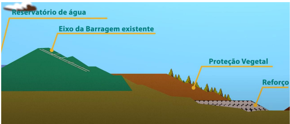
Figura 3– Ilustração da obra de reforço da Barragem 7, em Jeceaba/MG.
