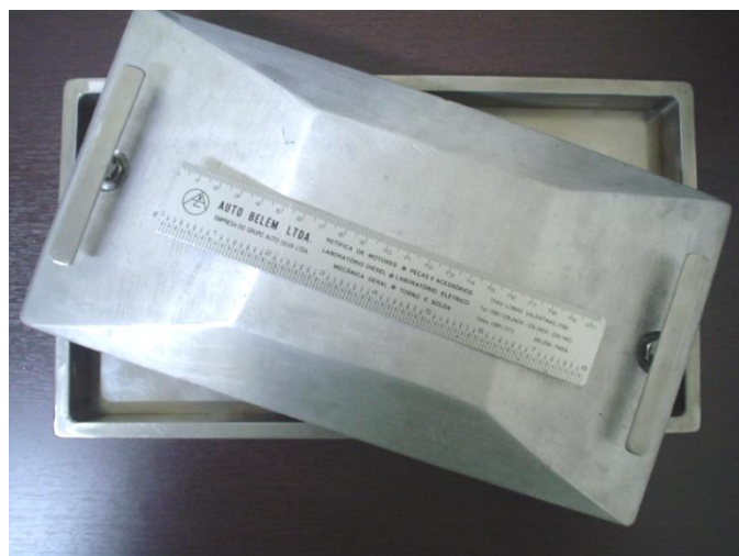
Figura 3.11 - Molde de aço inoxidável para conformação do compósito.
