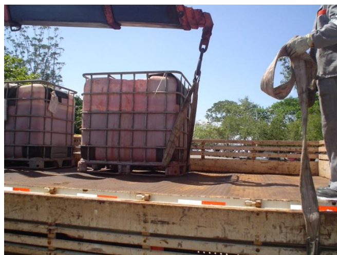
Figura - 3.7 Tanques de polietileno para o transporte de lama vermelha
