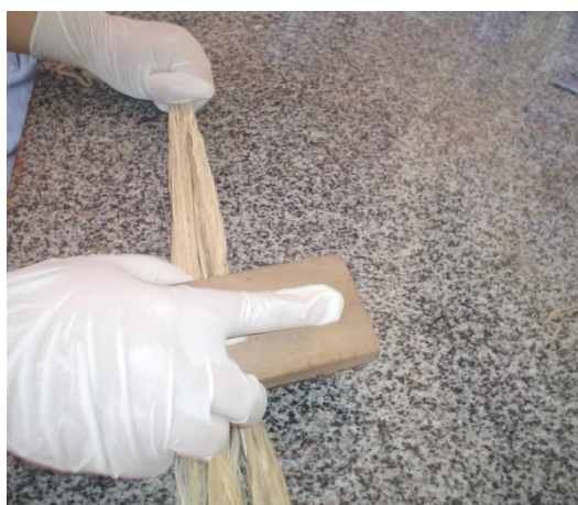
Figura 3.9 - Cardagem manual da fibra de curauá
