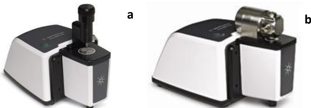
Figura 3.16 - Equipamento utilizado nas análises de espectroscopia no infravermelho com transformada de Fourier (a) por reflectância e (b) transmitância.
