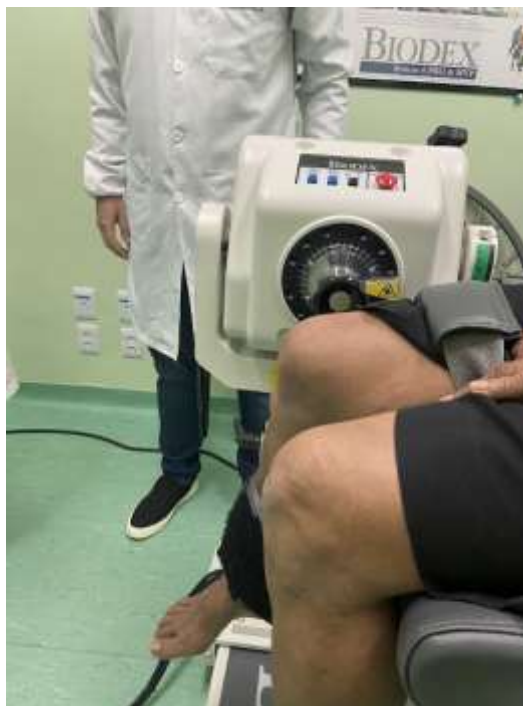
Figura 5: Alinhamento do eixo de rotação do dinamômetro
