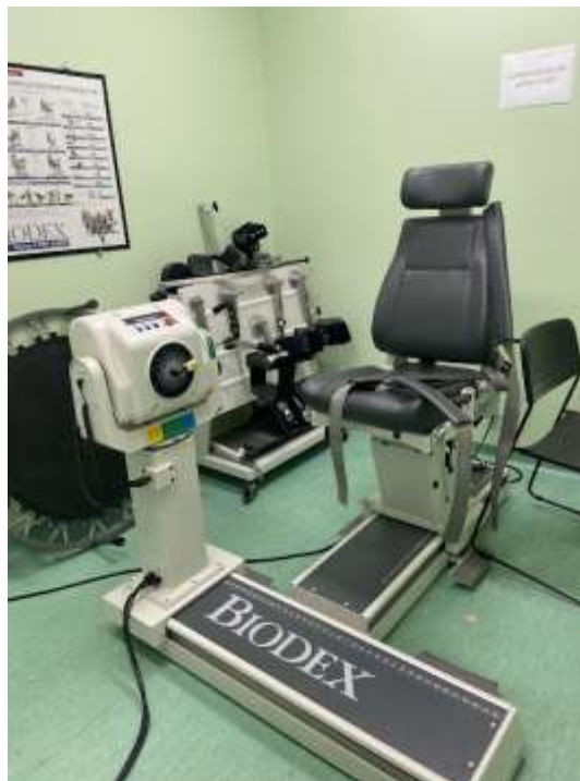
Figura 4: Dinamômetro isocinético Biodex System Pro 4
