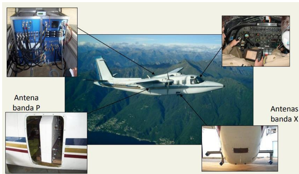
Figura 8 - Sensor banda X e banda P acoplado a aeronave bimotor
