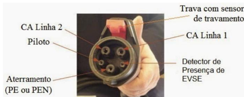
Figura 17 – Pinagem do Conector SAE-J1772
