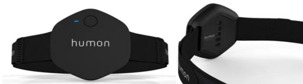
Figura 1 - Vista anterior e posterior do equipamento de Espectroscopia no Infravermelho Próximo (NIRS) - Humon Hex.
