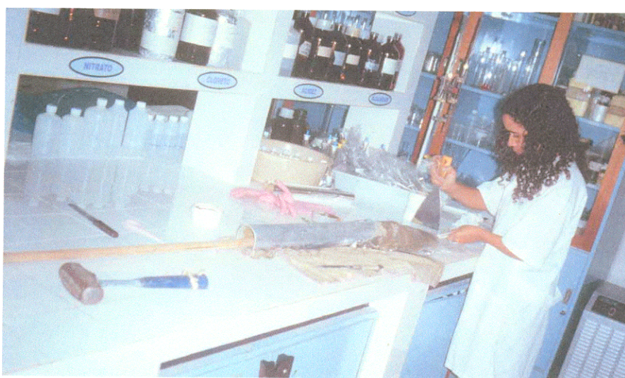
Figura 7: Retirada do testemunho de sedimento e seccionamento dos perfis (PF-01 e PF-02).
