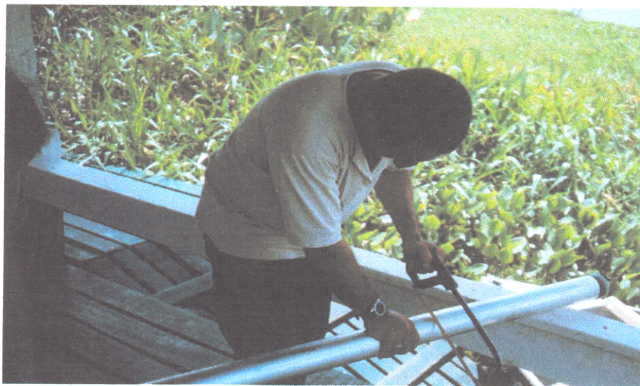
Figura 6: Separação da extremidade do tubo contendo o testemunho de sedimento.
