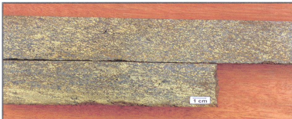
Figura 31: Zona de sulfeto maciço com presença de anfibólio e menor concentração de magnetita (furo ALM-FD09 – 633,72m a 633,50 m). Fonte: DOCEGEO (1998).
