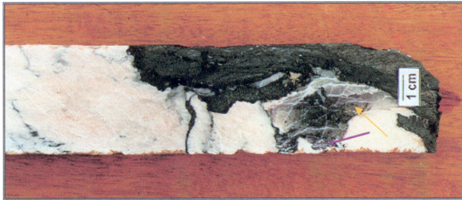
Figura 28: Veio de calcita com fluorita (seta lilás) e calcopirita (seta amarela), representativo da etapa de venulação carbonática tardia e encaixado em rocha vulcânica clorítica e minério magnetítico. Fonte: DOCEGEO (1998).
