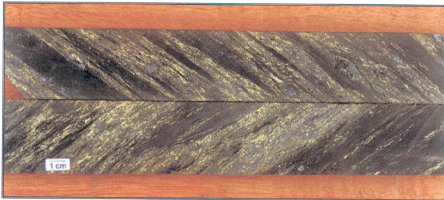
Figura 16: Brecha hidrotermal com fragmentos de metavulcânica bastante estirados imersos em matriz foliada, anastomótica e constituída essencialmente por magnetita, anfibólio e calcopirita. Fonte: DOCEGEO (1998).
