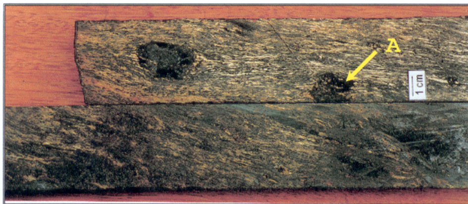
Figura 18: Brecha com fragmentos de metavulcânica imersos em matriz muito foliada rica em magnetita, calcopirita e clorita. Notar estiramento da calcopirita nas regiões de sombra de pressão e trama orientada versus aleatória da calcopirita no fragmento A (furo ALM-FD009 - 471,40m a 471,65 m). Fonte: DOCEGEO (1998).
