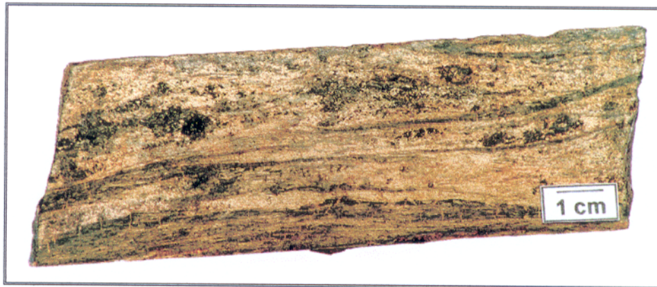
Figura 15: Zona de sulfeto maciço caracterizada pela alternância de níveis foliados anastomóticos (calcopirita e anfibólio) com níveis não foliados, amendoados (furo ALM-FD09). Fonte: DOCEGEO (1998).
