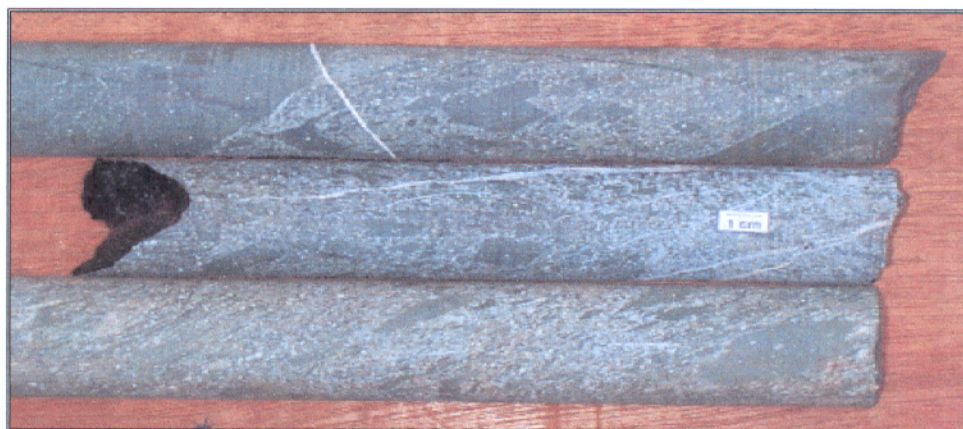
Figura 9: Metatufo de lápilli com fragmentos de rocha clorítica-quartzosa orientados e cristais de quartzo envolvidos por matriz fina composta essencialmente de quartzo e clorita. Fonte: DOCEGEO (1998).
