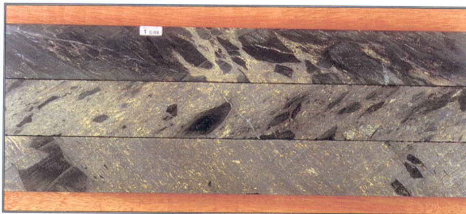
Figura 17: Brecha hidrotermal mostrando graus diversos de deformação/estiramento dos fragmentos de metavulcânica, imersos em matriz foliada e constituída essencialmente por magnetita, anfibólio e calcopirita (furo ALM-FD031 - 425,30m a 426,00 m). Fonte: DOCEGEO (1998).
